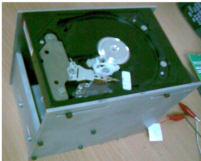
ภาพที่ 18 ชุดทดลองหัวอ่านฮาร์ดดิสก์ (Maxtor รุ่น Diamondmax plus 8 ขนาดความจุ 40 GB)
