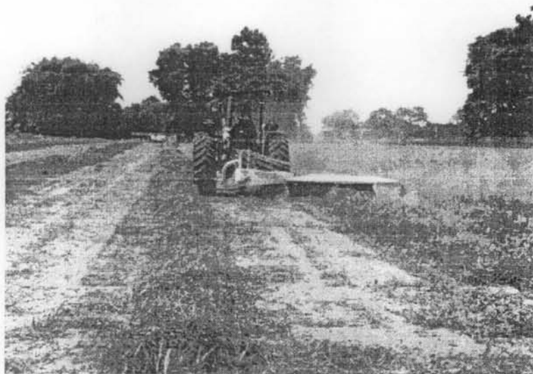
ภาพที่ 4 การตัดถั่วคาวลเคตโดยใช้เครื่องตัดหญ้าติดท้ายรถแทรกเตอร์ 1
