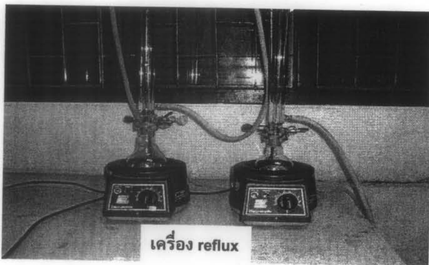
รูปผนวกที่ 2 แสดงการเปลี่ยนสีและเครื่องมือ reflux ในการวัดปริมาณ total lactone จากปฏิกิริยา ณ จุดสมดุล (Titration)
