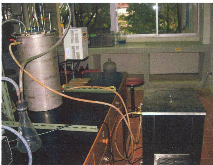
รูปภาคผนวก ง. ที่ 11 การควบคุมอุณหภูมิถึงหมักด้วยการใช้ระบบน้ำไหลเวียนจากอ่างน้ำร้อน ภายนอกที่ตั้งค่าอุณหภูมิตามความต้องการของถังหมัก
