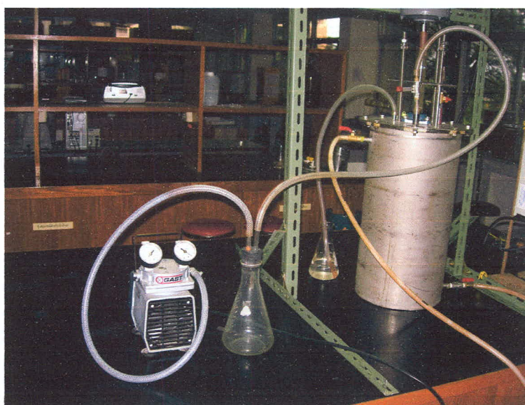
รูปภาคผนวก ง. ที่ 10 อุปกรณ์สำหรับการดึงตัวอย่างด้วยปั๊มสุญญากาศต่อกับท่อสุญญากาศในถัง
