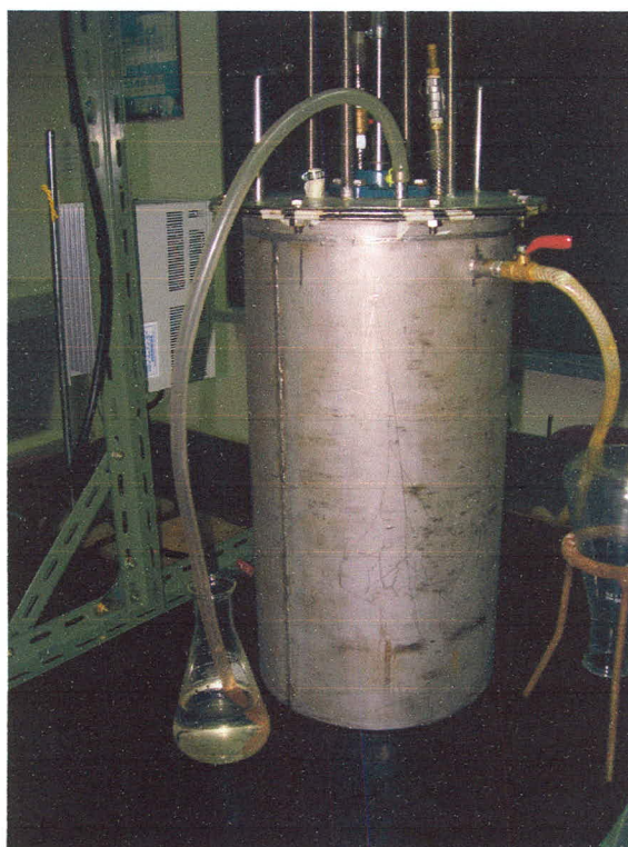
รูปภาคผนวก ง. ที่ 8 แสดงการประยุกต์ใช้ Air lock กักขยะจากถังหมักออกภายนอกแต่อากาศภายนอกไม่สามารถไหลเข้าสู่ภายในถังหมักได้
