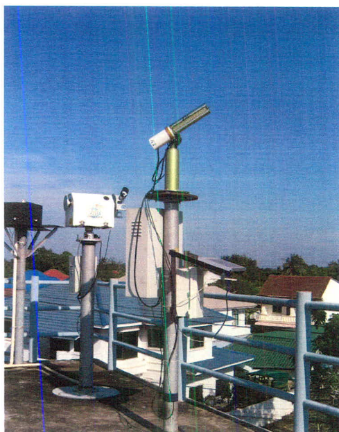
รูปที่ 3.2 ภาพเครื่อง sunphotometer ที่ติดตั้งที่จังหวัดอุบลราชธานี
