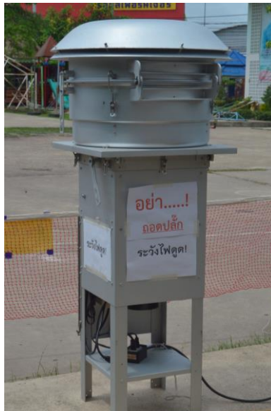
รูปที่ 3.10 เครื่องเก็บตัวอย่างฝุ่นละอองขนาดไม่เกิน 10 ไมครอนชนิดแรงดูดสูง
