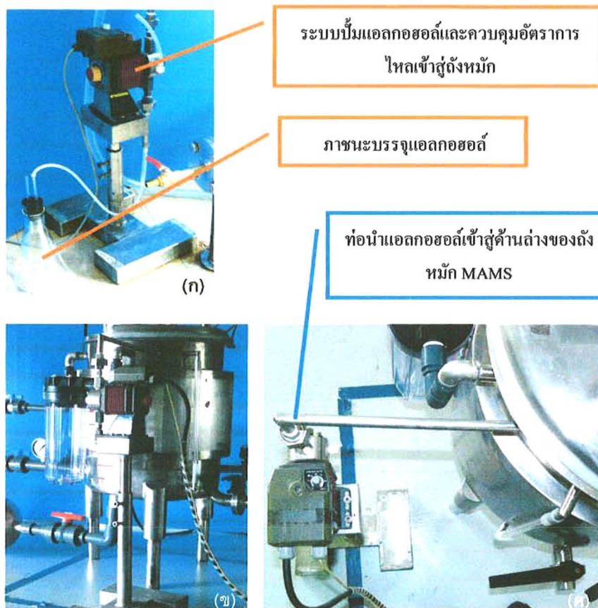
ภาพที่ 2 การติดตั้งระบบปั๊มแอลกอฮอล์และควบคุมการไหลเข้าสู่ถังหมักต้นแบบของระบบผสมน้ำหมักเข้ากับอากาศ (mash-air mixing system; “MAMS”) ขนาด 50 ลิตร : (ก) ระบบปั๊มแอลกอฮอล์และควบคุมการไหลเข้า; (ข) ถังหมัก “MAMS” ที่ติดตั้งระบบปั๊มแอลกอฮอล์และควบคุมการไหลเข้า; (ค) ท่อนำแอลกอฮอล์เข้าสู่ด้านล่างของถังหมัก “MAMS”
