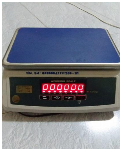
รูปที่ ง-8 ตาชั่งดิจิตอลใช้ชั่งน้ำหนักยางพาราแบบแผ่นเพื่อหาค่าความชื้นที่หายไป สามารถชั่งได้สูงสุด 15 กิโลกรัม ต่ำสุด 40 กรัม
