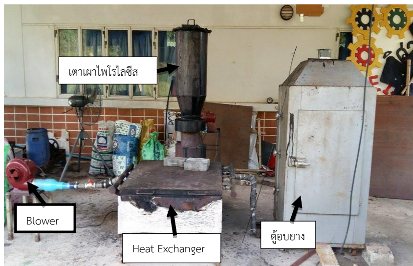
รูปที่ ง-1 แสดงรายละเอียดเกี่ยวกับกระบวนการอบย่างพาราแบบแผ่นด้วยเตาเผาชีวมวล เตาเผาไพโรไลซิส Blower Heat Exchanger Thermocouple และตู้บียงแผ่น
