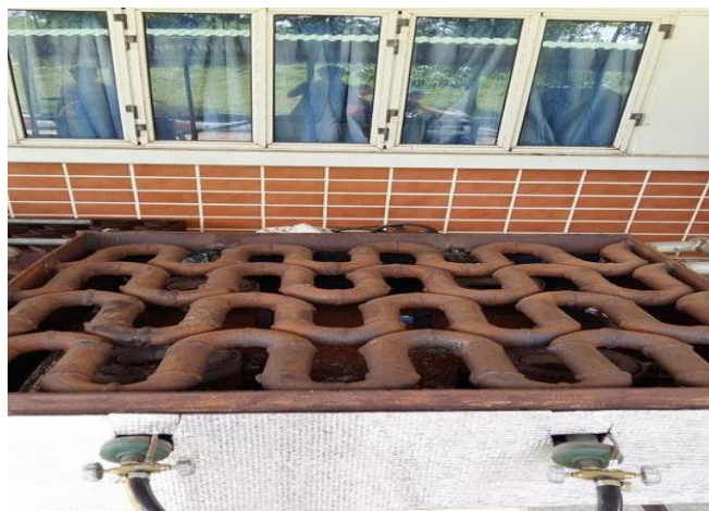
รูปที่ ง-4 Heat Exchanger ออกแบบมีลักษณะเป็นสี่เหลี่ยม ขนาด 85x90 เซนติเมตร สูง 42 เซนติเมตร ใช้เหล็กแผ่นขนาด 3 มิลลิเมตร ภายในชุด Heat Exchanger จะเป็นท่อขด ขนาด 2 นิ้ว จำนวน 4 ขด เพื่อแลกเปลี่ยนความร้อนระหว่างเปลวไฟกับอากาศอุณหภูมิห้องที่ไหลภายในท่อขดโดยการเป่าของ Blower
