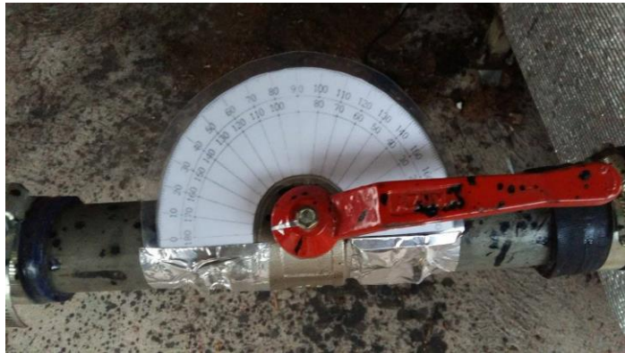
รูปที่ ง-7 ชุดวาล์วควบคุมอัตราการไหลของอากาศ ทำหน้าที่ควบคุมอัตราการไหลของอากาศก่อนเข้า ชุด Heat Exchanger
