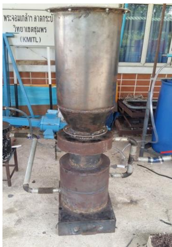
รูปที่ ง-2 การสร้างเตาเผาไพโรไลซิส ออกแบบโดยเตาผลิตแก๊สชีวมวลแบบไหลลง โดยคอคอดมีขนาดเส้นผ่านศูนย์กลาง 20 เซนติเมตร ใช้เหล็กหนาขนาด 6 มิลลิเมตร ซึ่งเป็นแบบคอคอดตรงและในส่วนของฮอปเปอร์มีขนาด 36 เซนติเมตร ใช้เหล็กหนาขนาด 3 มิลลิเมตร
