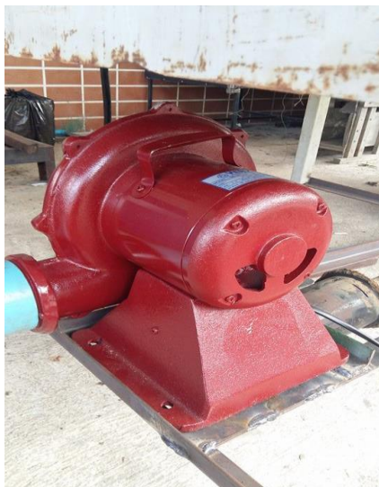
รูปที่ ง-3 Blower เป็นชุดเป่าลมร้อนจาก Heat Exchanger เข้าสู่ภายในตู้อบและเข้าสู่เตาเผาชีวมวลมีกำลัง 1/5 HP ขนาด 3 นิ้ว ความเร็วรอบ 3000 rpm
