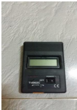
รูปที่ ง-5 Thermocouple เป็นอุปกรณ์วัดอุณหภูมิในแต่ละจุดภายในตู้อบย่าง ยี่ห้อ DenKi type t
