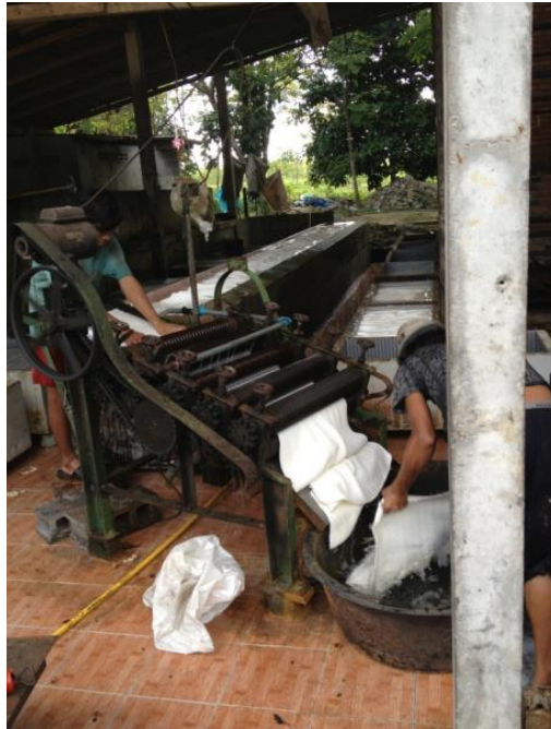
รูปที่ 3.7 จัดเตรียมยางพาราอัดแผ่นให้ได้ขนาดตามกำหนด พร้อมทั้งทำความสะอาดและตากยางให้สะเด็ดน้ำให้แห้งจนไม่มีหยดน้ำเกาะแผ่นยาง อย่างน้อย 6 ชั่วโมง
