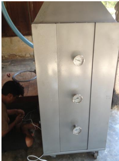
รูปที่ 3.6 ตู้อบยางที่ที่ได้รับลมร้อน ควบคุมให้ตู้อย่างมีอุณหภูมิ 50-60 องศา ในทุกตำแหน่ง
