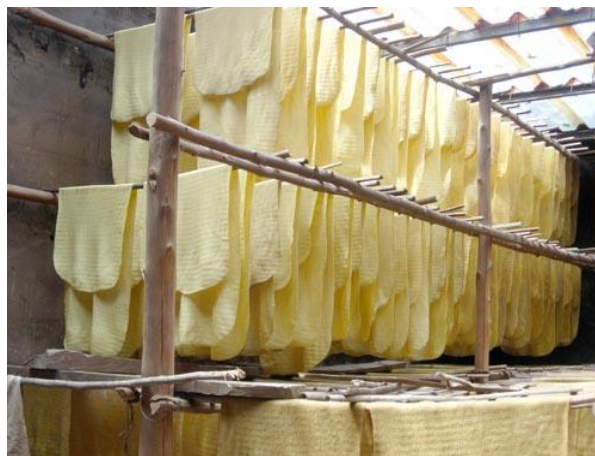
รูปที่ 1.2 การผึ่งยางรีดแผ่นให้แห้งบนราวตากยาง [2]
