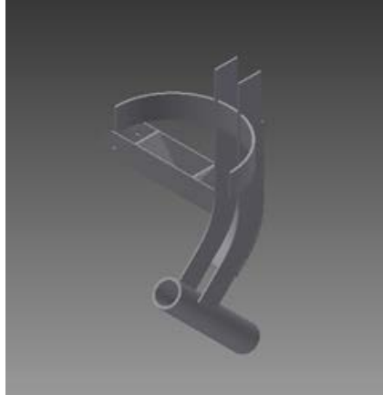
ภาพที่ 3.10 แบบแสดงส่วนยึดตัวถังบรรจุเมล็ด
