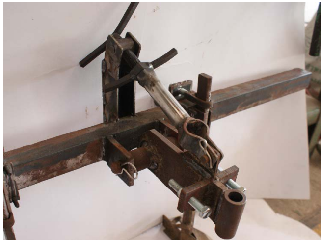
ภาพที่ ข 4. ส่วนที่ติดตั้งกับรถไถเดินตามและตัวปรับความลึกของอุปกรณ์เปิดร่อง
