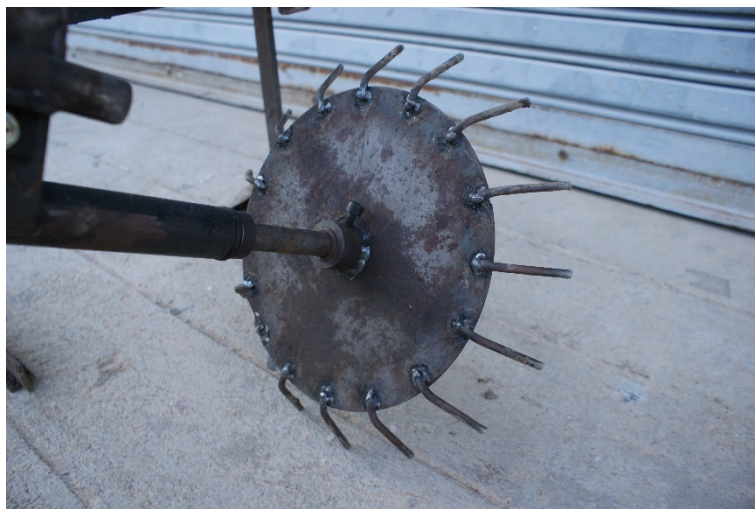
ภาพที่ ข 10. ล้อขับและเพลาคู่กับอุปกรณ์กำหนดเมล็ดข้าว
