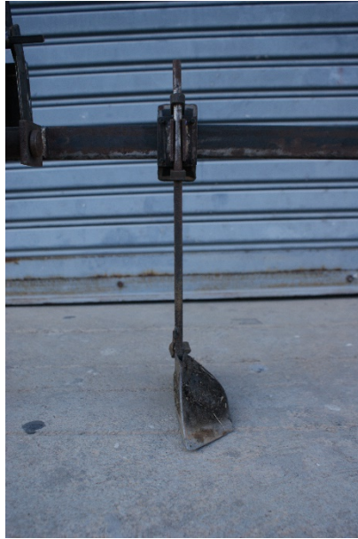
ภาพที่ ข 5. อุปกรณ์ (ผาน) เปิดร่องดิน
