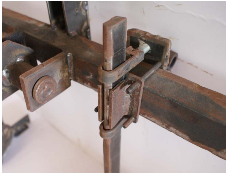
ภาพที่ ข 6. ส่วนที่ยึดอุปกรณ์ (ผาน)เปิดร่อง
