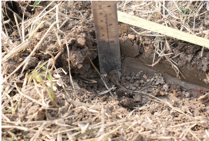
ภาพที่ ข 13. ขนาดความลึกของดินที่ทำการเปิดร่องด้วยอุปกรณ์เปิดร่อง (ผาน)
