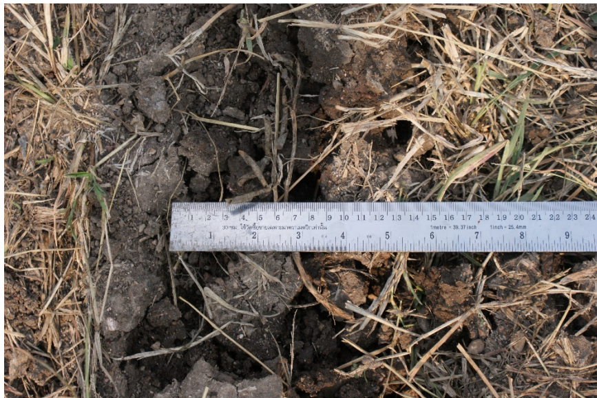
ภาพที่ ข 14. ขนาดความกว้างของดินที่ทำการเปิดร่องด้วยอุปกรณ์เปิดร่อง
