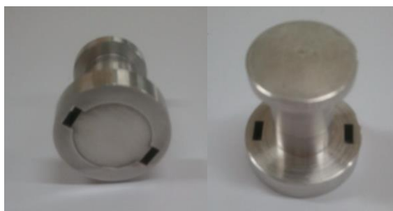
ภาพที่ 4 sample cell สำหรับใช้วัดสเปกตรัม NIR ของตัวอย่างน้ำตาลโดนดสด
