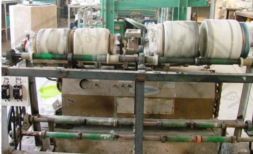
รูป ข-5 เครื่องบดแบบ Pot Mill พร้อมหม้อบด สำหรับบดดิน และผสมส่วนผสมให้เป็นเนื้อเดียวกัน
