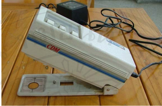
รูป ข-9 เครื่องวัดสี X-Rite สำหรับวัดความขาวสว่างและความโปร่งแสง
