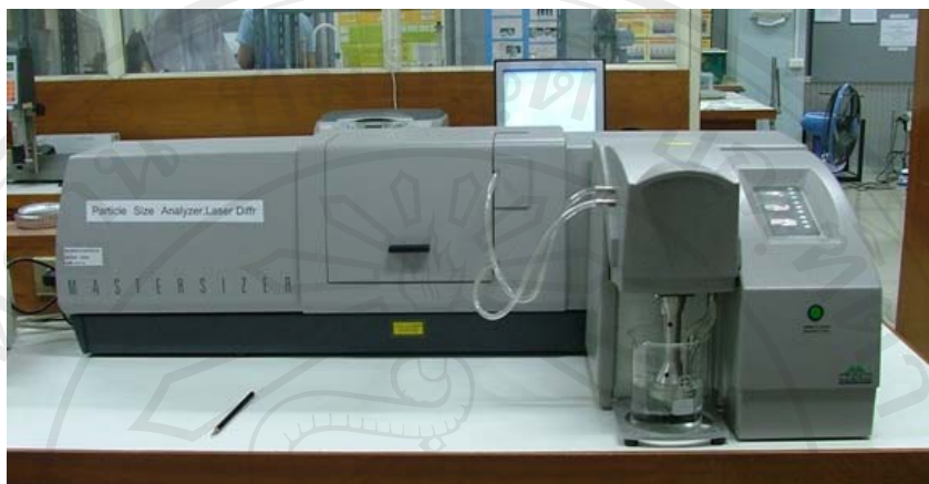
รูป ข-7 เครื่องวิเคราะห์ขนาดและการกระจายอนุภาค
