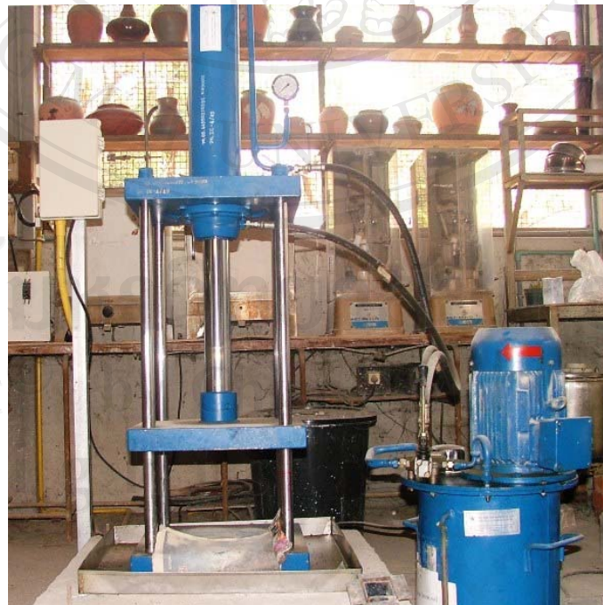
รูป ข-4 เครื่องอัด Hydraulic ขนาด 30 ตัน สำหรับอัดขึ้นรูปชิ้นทดสอบแบบต่างๆ
