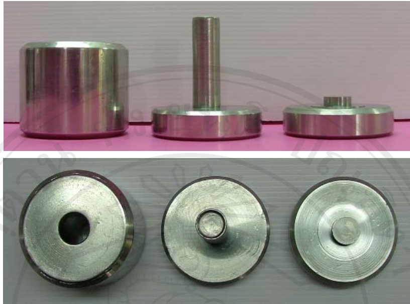
รูป ข-3 แม่พิมพ์โลหะขนาดเส้นผ่านศูนย์กลาง 1.5 เซนติเมตร สูง 4 เซนติเมตร สำหรับขึ้นรูปชิ้นทดสอบแบบแท่ง
