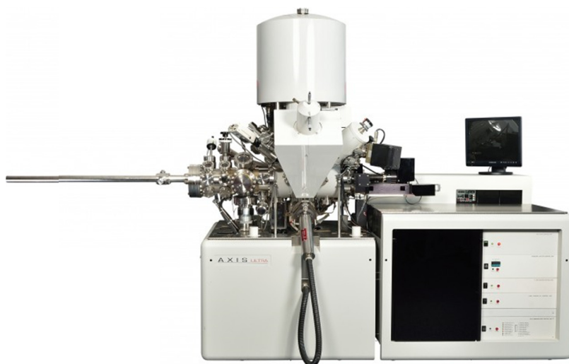
ภาพที่ 3.6 X-ray photoemission spectroscopy
