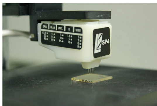
ภาพที่ 3.7 Four-point probe technique
