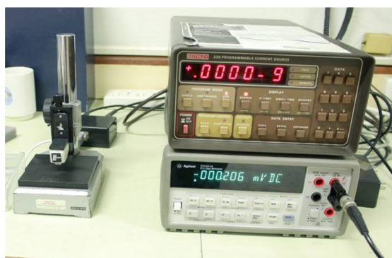
ภาพที่ 3.7 Four-point probe technique
