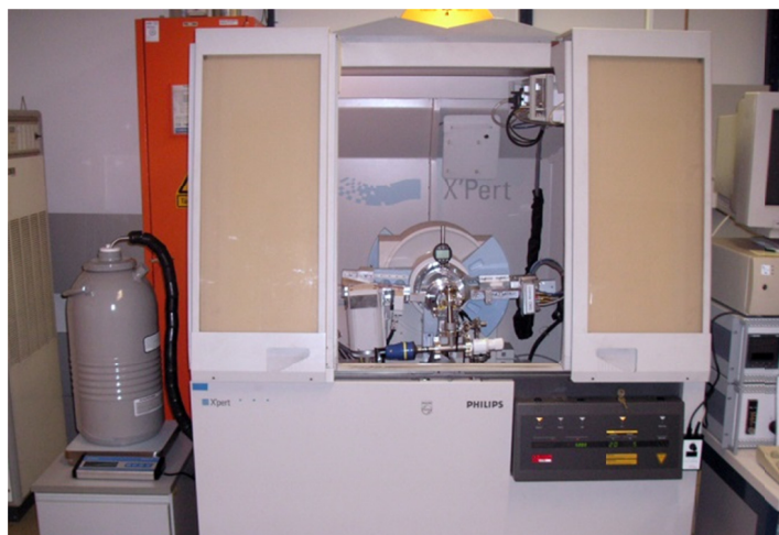
ภาพที่ 3.4 PHILIPS X'Pert-MPD XRD Diffractometer
