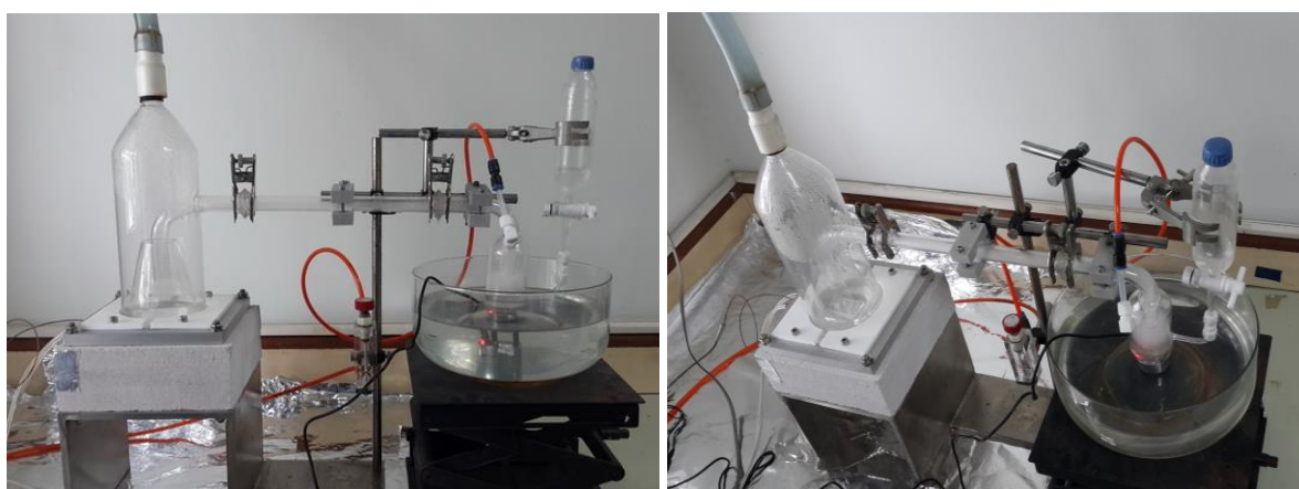
รูปที่ 13 ภาพถ่ายระบบการสังเคราะห์ฟิล์มบาง \text{SnO}_2 ด้วยเทคนิค UPS (a) มุมมองด้านหน้า (b) มุมมองด้านบน
