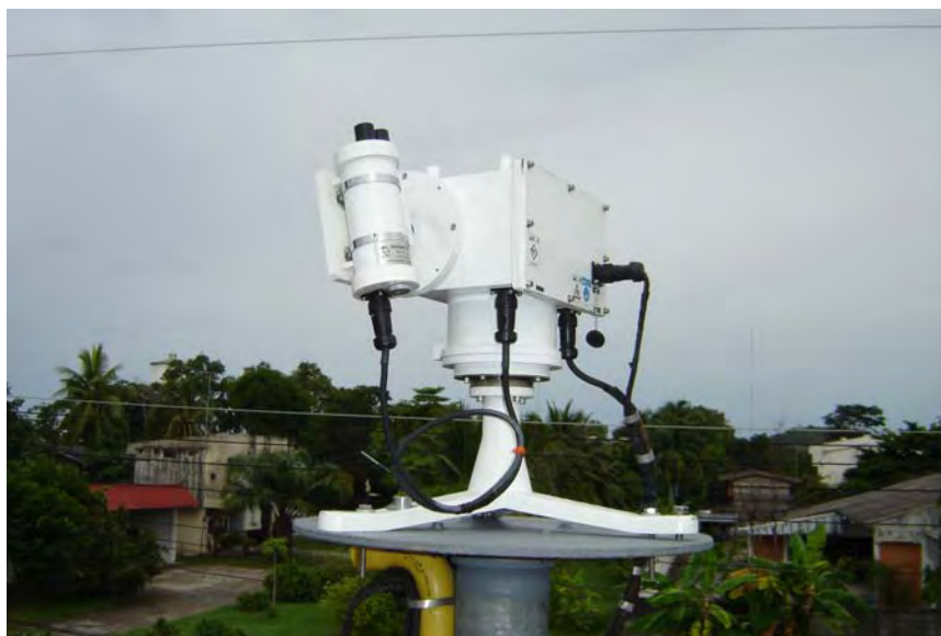
รูปที่ 3.2 แสดงเครื่อง sky scanner ซึ่งติดตั้งที่ศูนย์อุตุนิยมวิทยาภาคใต้ฝั่งตะวันออก จังหวัดสงขลา
