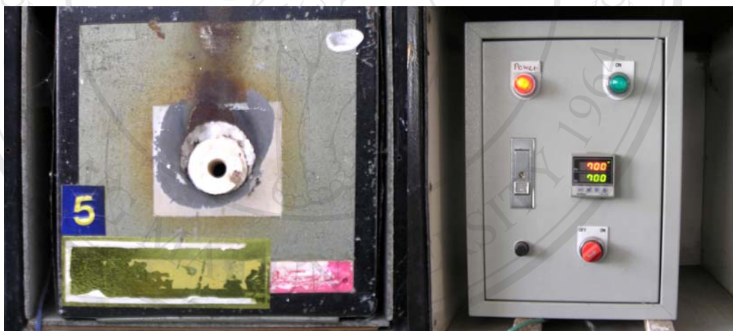
รูปที่ 3.10 แสดงเตาเผาแบบท่อแนวนอน (รูปซ้ายมือ) และ Controller ควบคุมอุณหภูมิ (รูปขวามือ) ของห้องวิจัยฟิสิกส์ประยุกต์ ภาควิชาฟิสิกส์ คณะวิทยาศาสตร์ มหาวิทยาลัยเชียงใหม่
