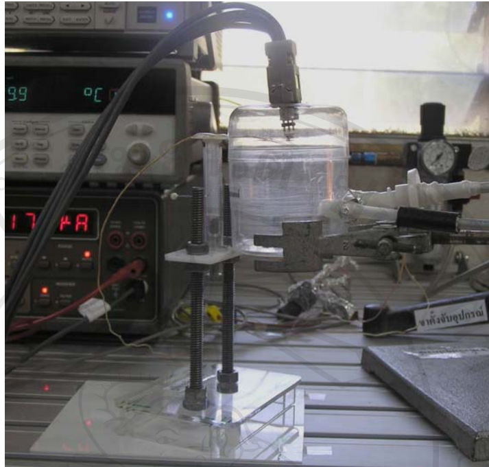
รูปที่ 3.23 แสดงแท่นยึด Thermocouple ที่ใช้ในการวัดอุณหภูมิของเซนเซอร์ก๊าซ
