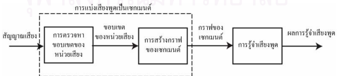
รูปที่ 2.16 แผนภาพส่วนประกอบของระบบรู้จำเสียงพูดแบบอาศัยเชกเมนต์
