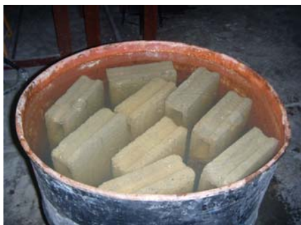
ภาพที่ จ.10(ก) แช่คอนกรีตบล็อกในน้ำ เป็นเวลา 5 ชั่วโมง
