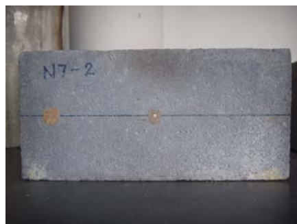
ภาพที่ จ.10(ง) หลังจากการทดสอบ คอนกรีตบล็อก ยังอยู่ในสภาพสมบูรณ์
