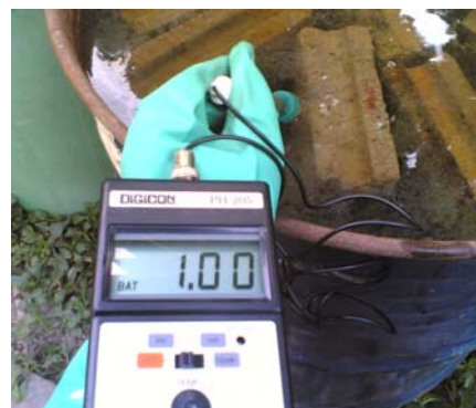
ภาพที่ จ.8(ข) แสดงการตรวจวัด ค่า pH ของน้ำกรดให้ได้เท่ากับ 1
