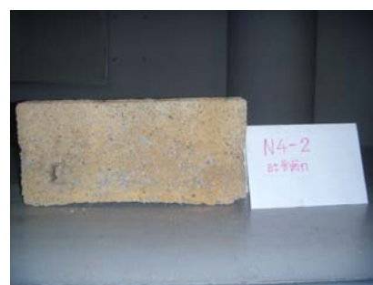
ภาพที่ จ.8(ฉ) สภาพคอนกรีตบล็อก หลังแช่กรดอะซิติก 90 วัน
