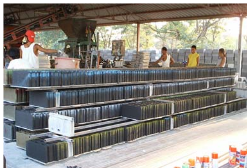
ภาพที่ จ.3(ง) การจัดเรียงคอนกรีตบล็อกที่ขึ้นรูปเสร็จ
