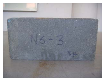
ภาพที่ จ.8(ง) สภาพคอนกรีตบล็อก หลังแช่กรดไนตริก 90 วัน
