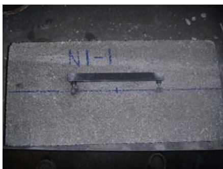
ภาพที่ ๙.๙(ก) วัดระยะด้วยแท่งเหล็กมาตรฐาน
