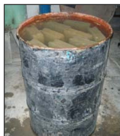
(ฏ) น้ำคอนกรีตบดล็อกบ่มโดยการแช่น้ำ
