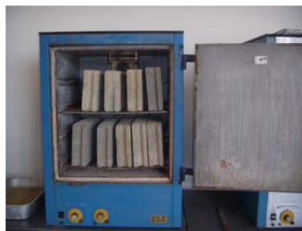
ภาพที่ จ.10(ข) อบที่อุณหภูมิ 110 องศาเซลเซียส เป็นเวลา 42 ชั่วโมง
