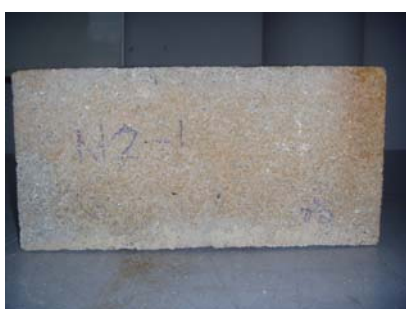
ภาพที่ จ.8(ค) สภาพคอนกรีตบล็อก หลังแช่กรดซัลฟูริก 90 วัน
