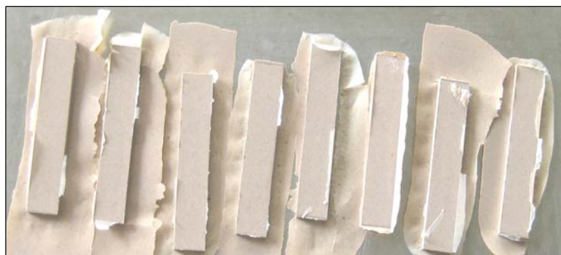
ภาพที่ 3.22 ชิ้นงานก่อนการตัดเศษส่วนเกินออก
