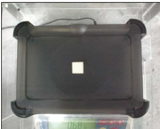
ภาพที่ 3.39 แสดงลักษณะการขังชิ้นงานตัวอย่างในอากาศ
