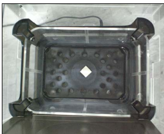
ภาพที่ 3.40 แสดงลักษณะการขังชิ้นงานตัวอย่างในน้ำ
