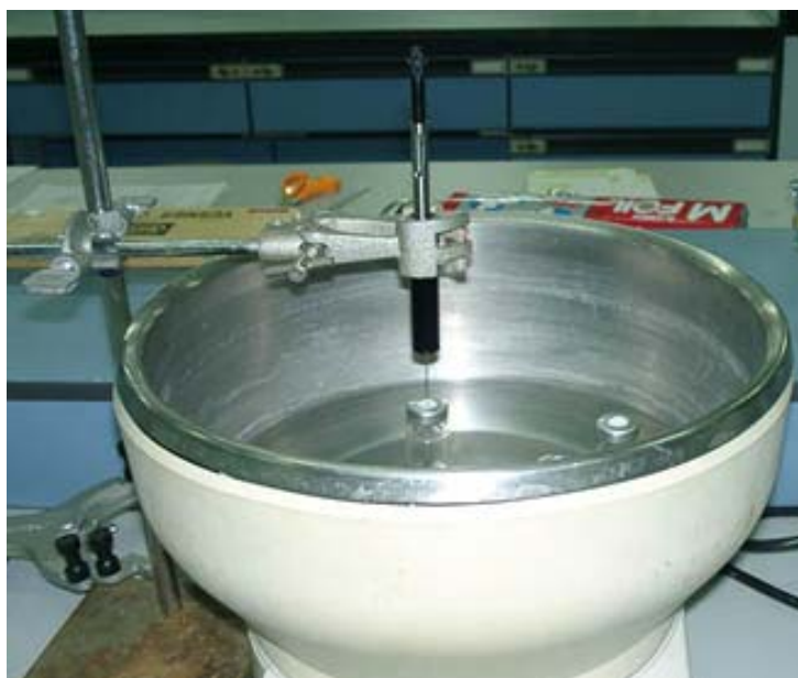
ภาพผนวกที่ 6 ลักษณะการวางอุปกรณ์ขณะทำการเก็บตัวอย่างของขวดใส่ตัวอย่างขนาด 20 มิลลิลิตร (vial) และ SPME
