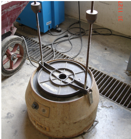
ภาพที่ ฐ.2 เครื่องทดสอบหาขนาดคละของทราย
