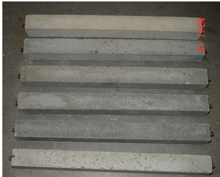
ภาพที่ ส.9 ตัวอย่างมอร์ต้าร์ทดสอบการหดตัวแบบแห้ง
