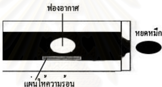
รูปที่ 2.10 การทำงานของเครื่องพิมพ์อิงค์เจ็ทแบบ Thermal
