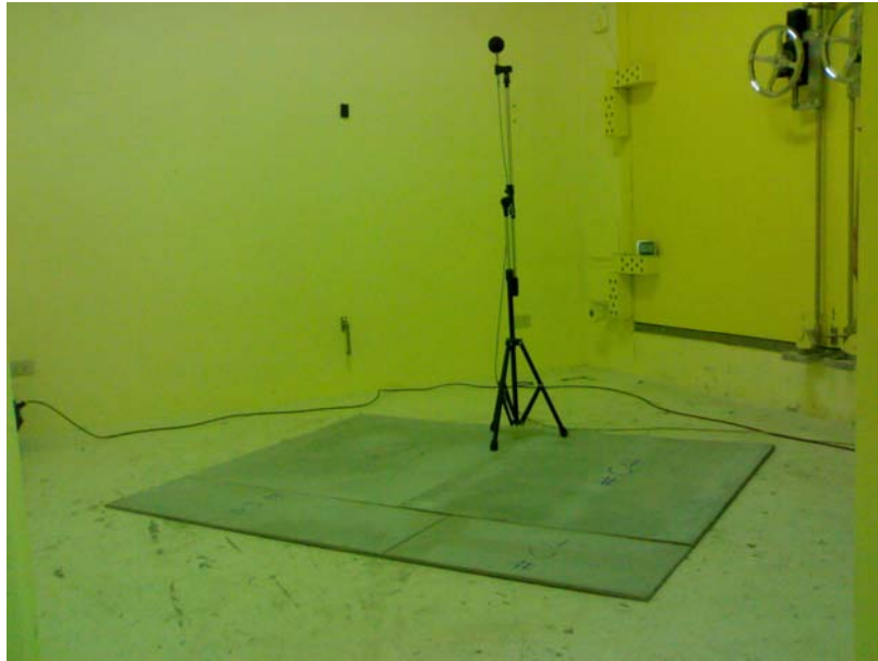
ภาพที่ ข-23 การทดสอบการดูดซับเสียงของปูนฉาบ
