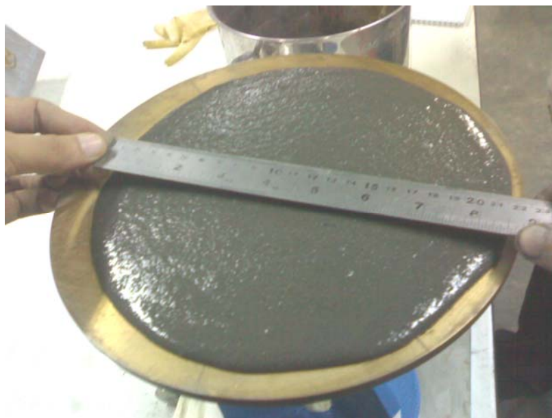
ภาพที่ ช-4 การวัดขนาดเส้นผ่านศูนย์กลางของปูนฉาบหลังทำการทดสอบ
