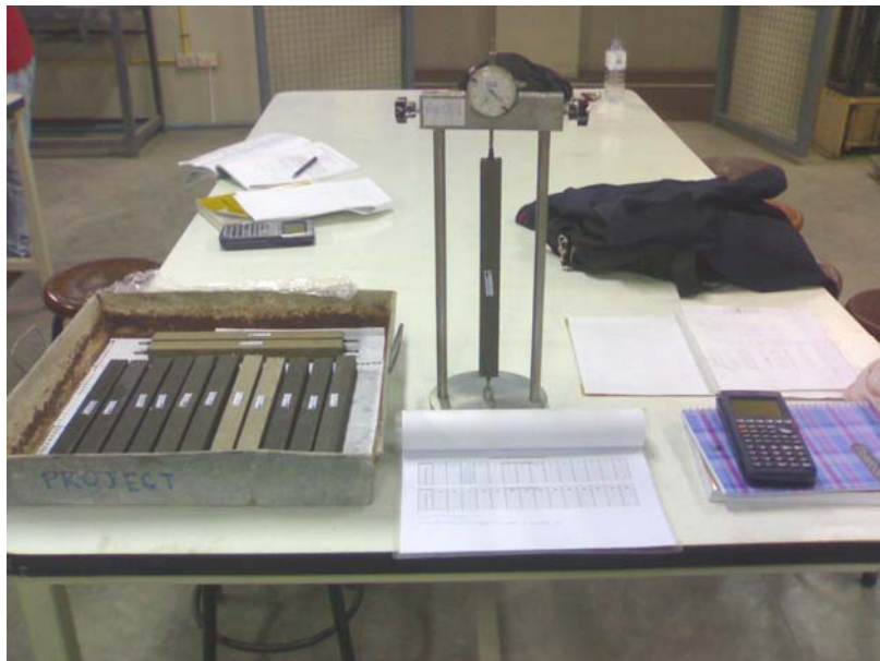
ภาพที่ ซ-18 การทดสอบการหดตัวแบบแห้ง
