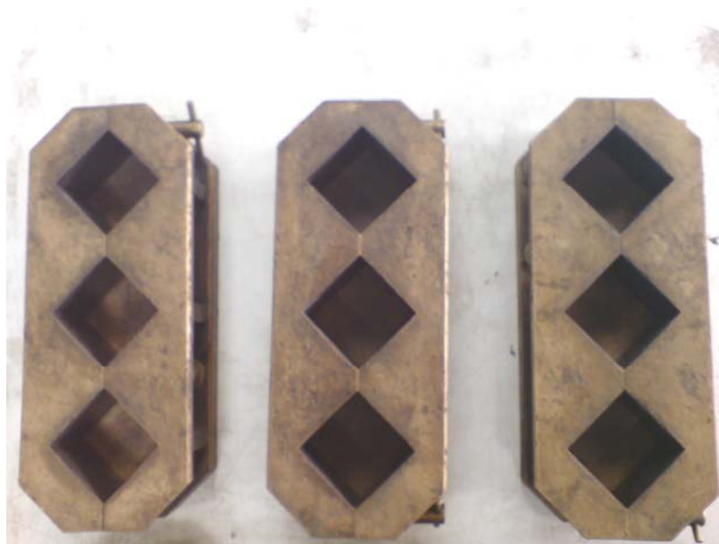
ภาพที่ ช-7 แบบหล่อที่ใช้ในการทดสอบกำลังต้านทานแรงอัด
