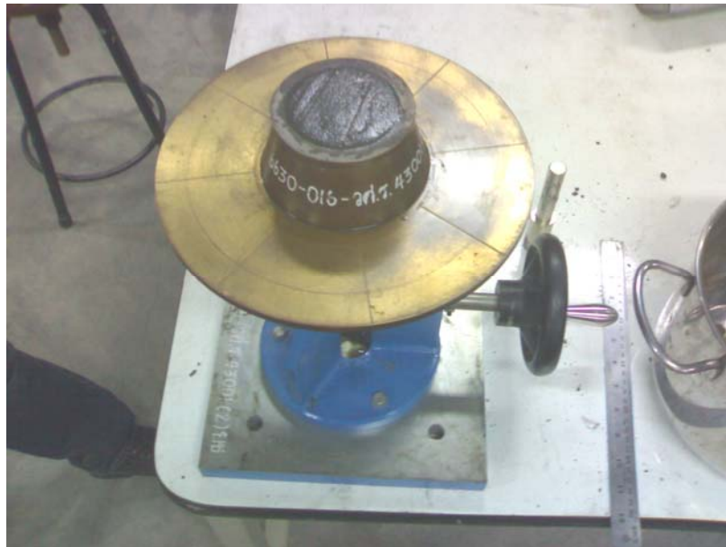
ภาพที่ ช-3 ปูนฉาบที่เทลงในแบบหล่อและแต่งหน้าปูนฉาบจนเรียบ
