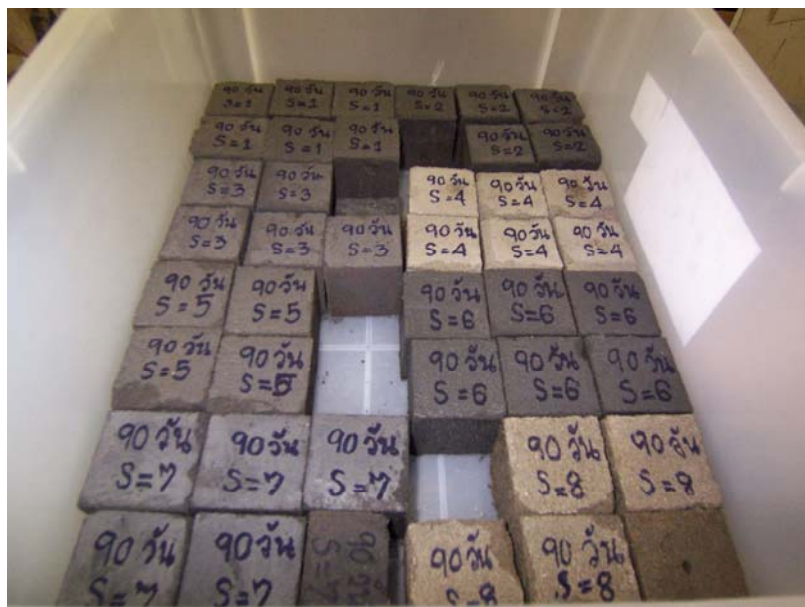
ภาพที่ ข-9 ลักษณะตัวอย่างก่อนทำการทดสอบกำลังต้านทานแรงอัด
