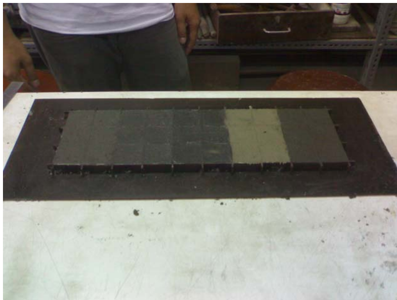
ภาพที่ ซ-19 ตัวอย่างการทดสอบการนำความร้อน
