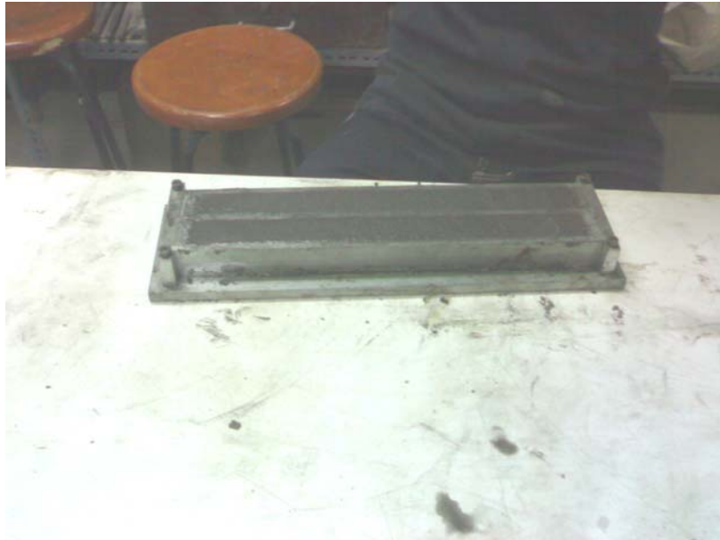
ภาพที่ ซ-17 ตัวอย่างแท่งทดสอบการหดตัวแบบแห้ง
