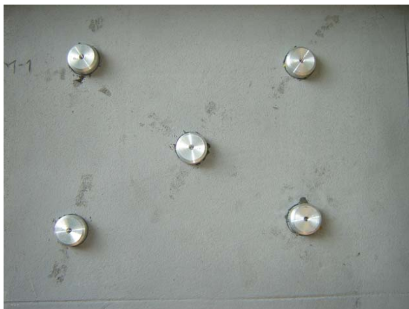
ภาพที่ ช-16 การทดสอบแรงอัดเหนียวของปูนฉาบ
