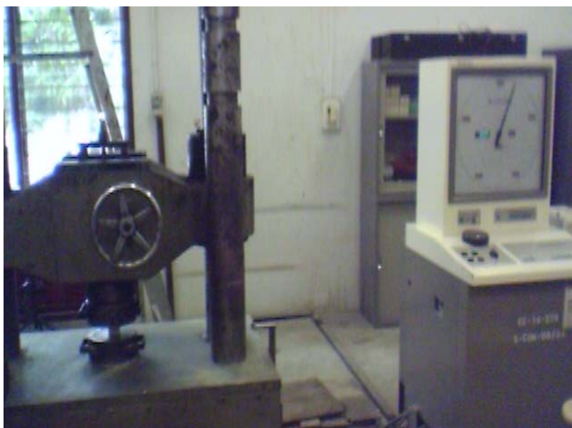
ภาพที่ ข-10 การทดสอบกำลังต้านทานแรงอัดของตัวอย่าง
