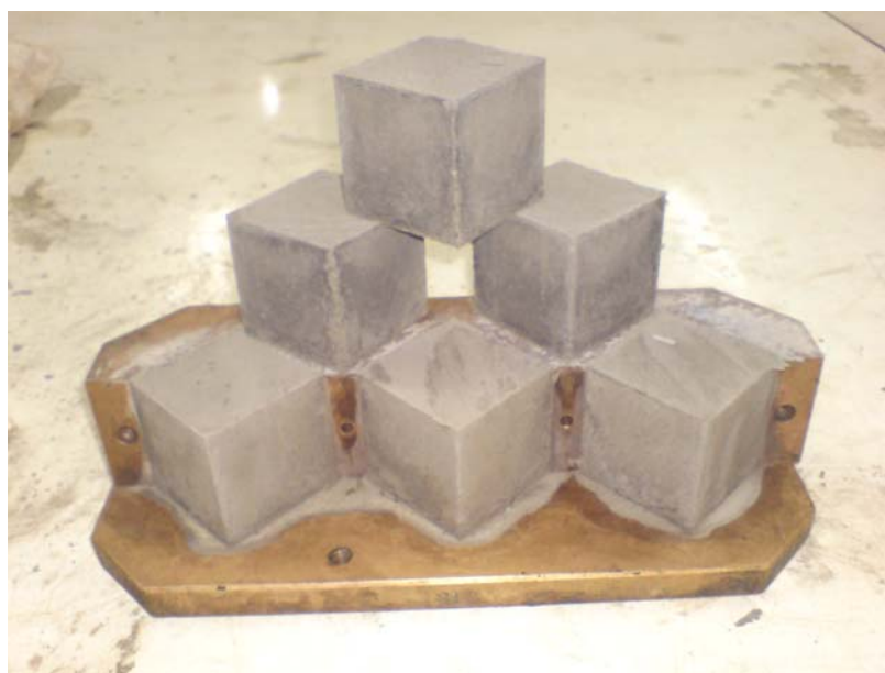
ภาพที่ ช-8 ตัวอย่างทดสอบขนาด 5 x 5 x 5 ซม. หลังถอดแบบหล่อ
