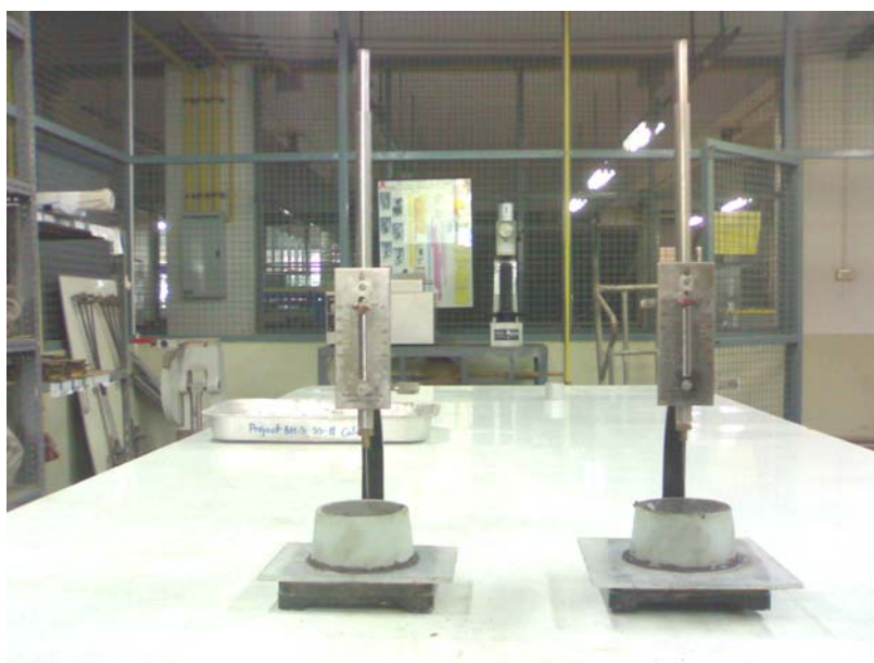
ภาพที่ ข-6 ปลั๊กเข็มของเครื่องมือวัดเวลาที่กำหนด
