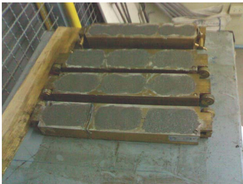
ภาพที่ ช-12 ตัวอย่างทดสอบกำลังต้านทานแรงดึงหลังจากแต่งหน้าเรียบเรียบร้อยแล้ว
