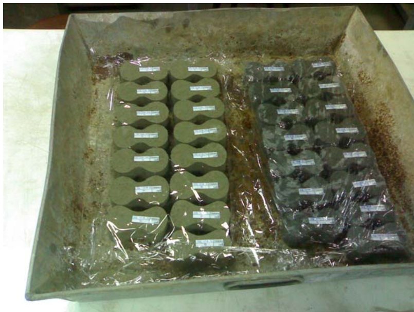
ภาพที่ ช-13 ตัวอย่างทดสอบกำลังต้านทานแรงดึงหลังจากการถอดแบบหล่อ
