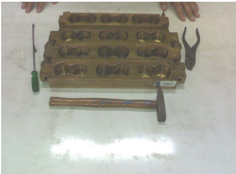
ภาพที่ ช-11 แบบหล่อปริเคทซึ่งใช้ในการทดสอบกำลังต้านทานแรงดึง
