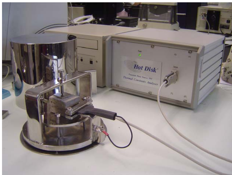
ภาพที่ ซ-20 การทดสอบการนำความร้อน
