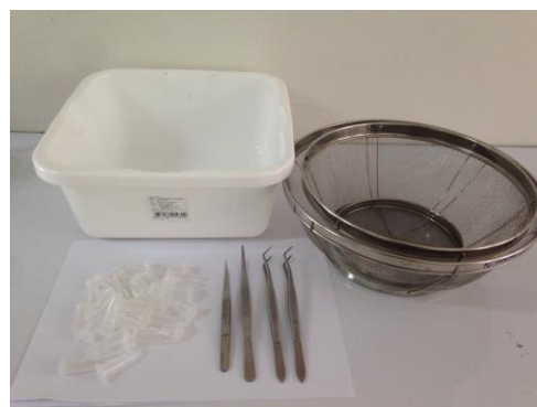
อุปกรณ์สำหรับเก็บตัวอย่างด้วยวิธีตะแกรงร่อน
