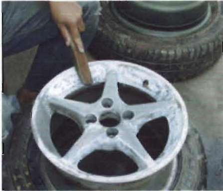
รูปที่ 6ก ภาพถ่ายการทำความสะอาดชิ้นงานหลังการลอกสีด้วยตัวทำละลาย
