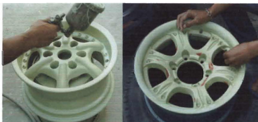
รูปที่ 9ก ภาพถ่ายขั้นตอนการพ่นสีรองพื้นและการปรับระดับพื้นผิว
