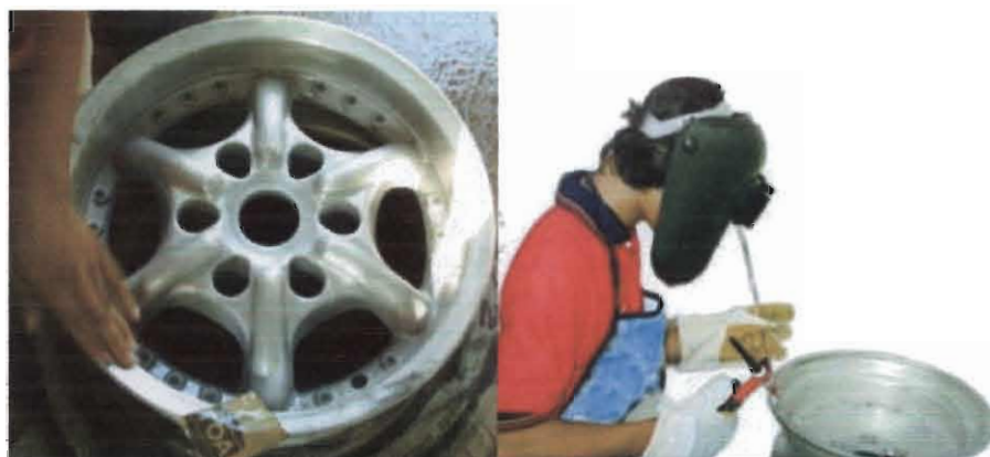
รูปที่ 8ก ภาพถ่ายขั้นตอนการปรับแต่งพื้นผิวอย่างละเอียดและการเชื่อมพื้นผิว
