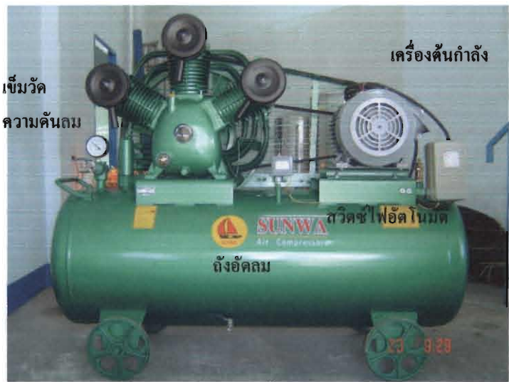
รูปที่ 1ก ภาพถ่ายเครื่องปั๊มลมชนิดลูกสูบ
