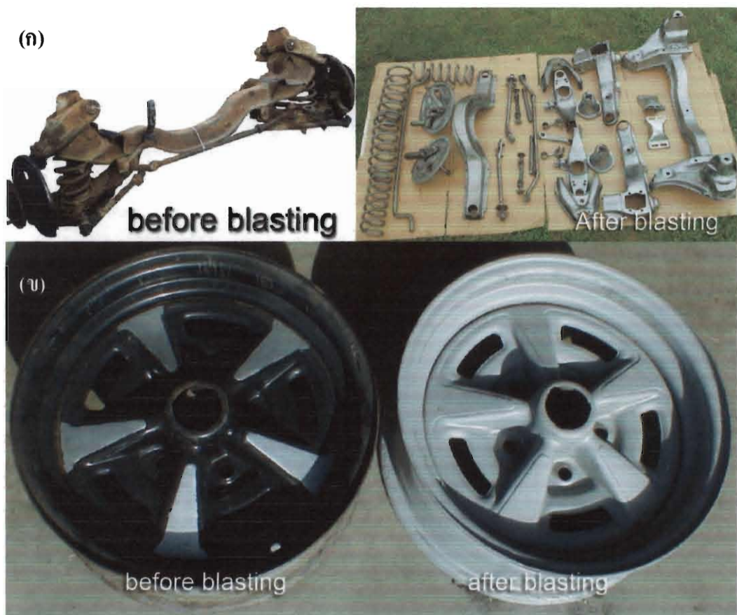
รูปที่ 2.2 (ก) ภาพถ่ายของช่วงล่างรถยนต์ ก่อนและหลังทำการพ่นทราย
