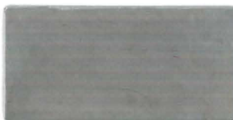
รูปที่ 3.1 แผ่นโลหะที่ตัดให้ขนาด 5x10 ตารางเซนติเมตรก่อนเคลือบรองพื้น
