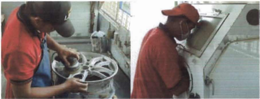
รูปที่ 7ก ภาพถ่ายการเตรียมพื้นผิวด้วยวิธีการขัดและพ่นทราย
