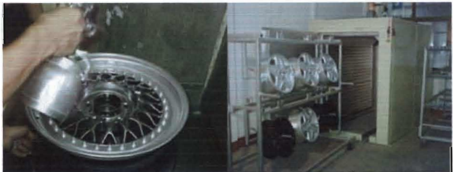
รูปที่ 11ก ภาพถ่ายขั้นตอนการเคลือบสีแลคเกอร์และนำชิ้นงานไปอบ
