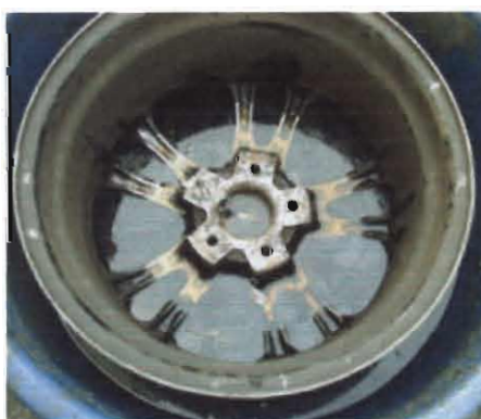
รูปที่ 5ก ภาพถ่ายลือแม็กซ์ขณะทำการลอกสีด้วยวิธีการจุ่มในตัวทำลาย
