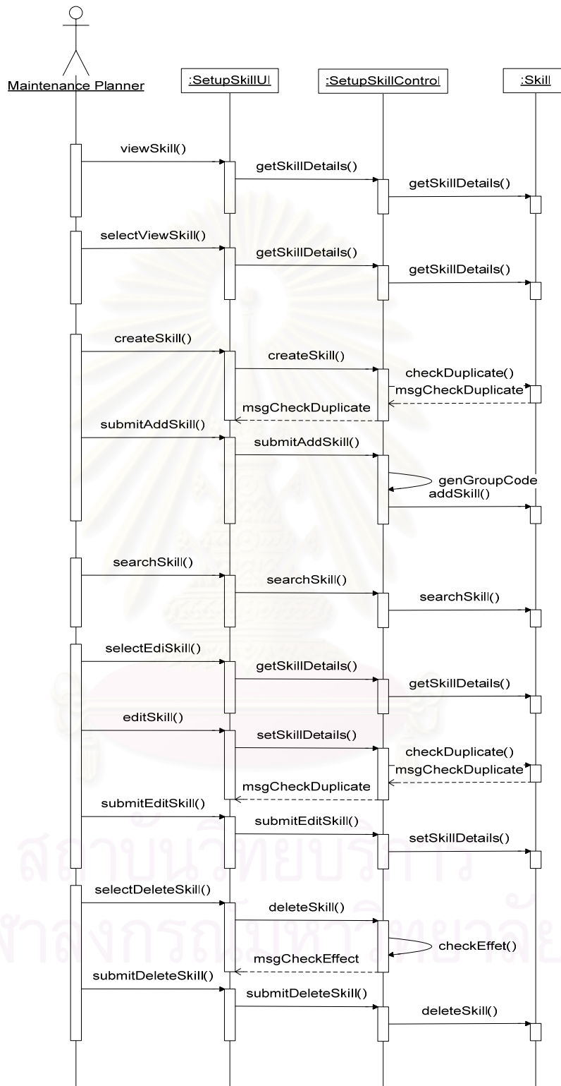
รูปที่ ค.6 แผนภาพลำดับการทำงานของกาติดตั้งค่าทักษะพนักงาน (Setup Skill)
