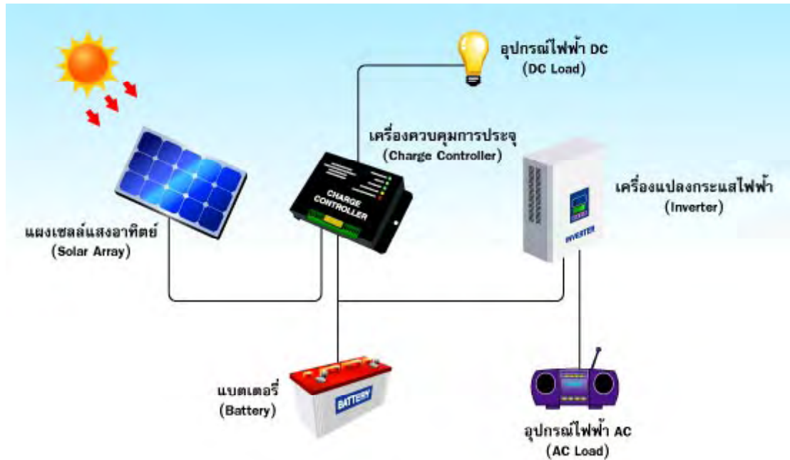
รูปที่ 2.4 ระบบการผลิตกระแสไฟฟ้าจากแผงโซลาร์เซลล์
