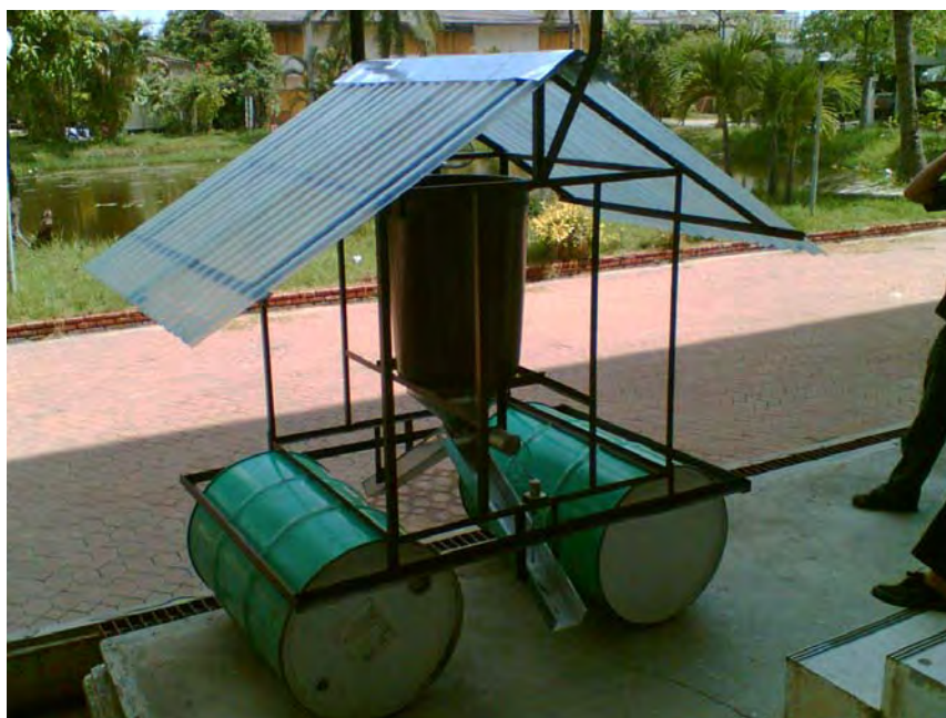
รูปที่ 3.1 รูปลักษณะของเครื่องให้อาหารปลาบ่อพันธุ์ปลานิลแบบหมุนลอยโดยพลังงานแสงอาทิตย์
