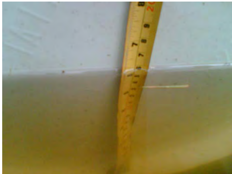
รูปที่ 3.9 ระดับตัวถังที่จมน้ำขณะที่ยังไม่ใส่อาหาร
