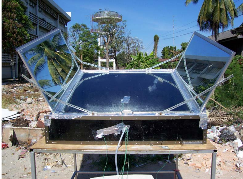
รูปที่ 3.3 ภาพเครื่องผลิตเกลือสินเธาว์พลังงานแสงอาทิตย์
