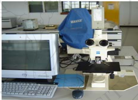
รูป 3.14 กล้องจุลทรรศน์แสง และชุดโปรแกรมวิเคราะห์หาค่าความพรุน จากภาพถ่าย AXIOVS40 version 4.2
