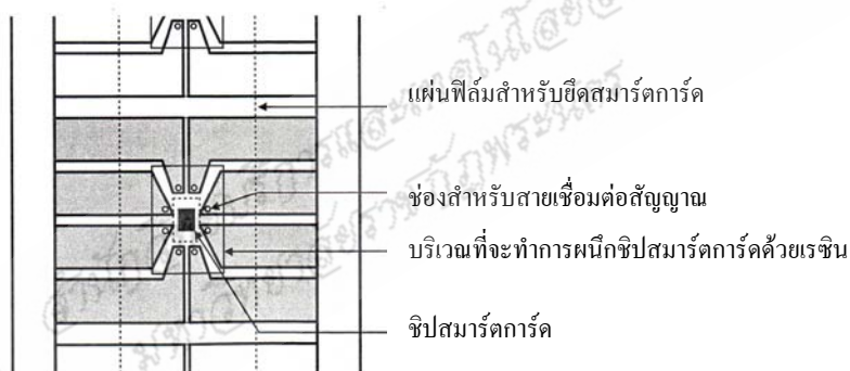
ภาพที่ 2.9 ส่วนประกอบของสมาร์ทการ์ดโมดูลในสายการผลิตสมาร์ทการ์ด
