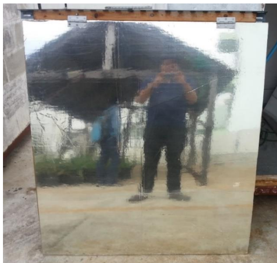
รูปที่ 3.7 แผ่นสะท้อนสำหรับสะท้อนให้รังสีอาทิตย์ตกกระทบลงบนแผงโฟโตโวลตาอิก
