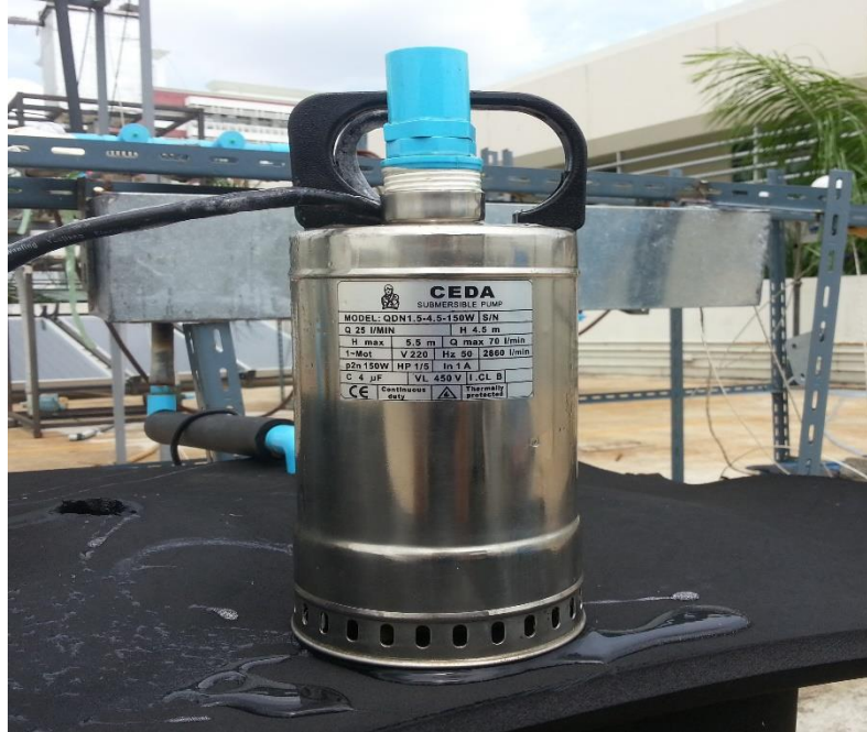
รูปที่ 3.6 เครื่องสูบน้ำยี่ห้อ CEDA รุ่น QDN 1.5-4.5-150 W ขนาด 150 วัตต์
