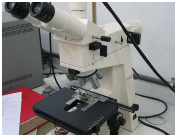
รูปที่ 3.19 แสดงวิธีการตรวจสอบโครงสร้างของชิ้นงานทดลองด้วยกล้องจุลทรรศน์
