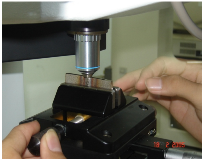
รูปที่ 3.17 แสดงวิธีการทดสอบความแข็งแบบวิกเกอร์ส (Vickers Hardness test)
