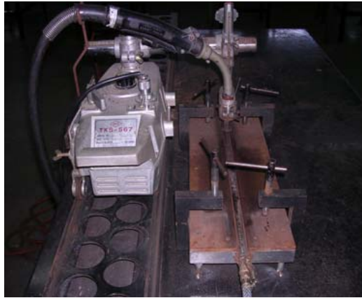
รูปที่ 3.12 แสดงการจับยึดชิ้นงานก่อนการเชื่อมโดยใช้แผ่นทองแดงประกบด้านหลัง
