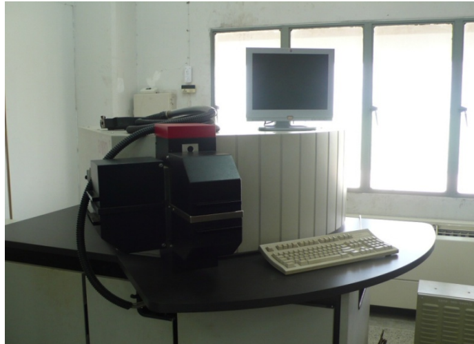
รูปที่ 3.6 เครื่องวิเคราะห์ส่วนผสมธาตุ (Optical Emission Spectro Meter) รุ่น DV 6
