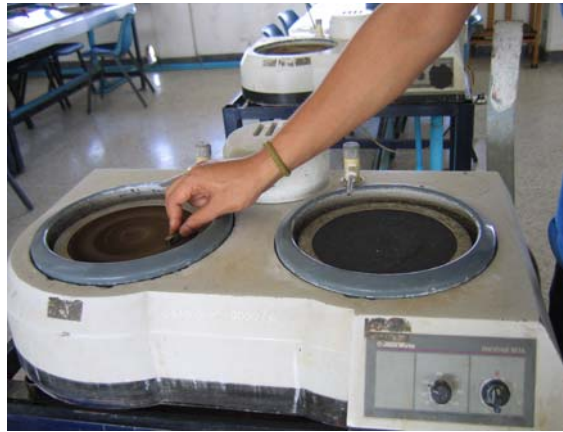
รูปที่ 3.18 แสดงการจัดชิ้นงานทดสอบ (Specimen) ด้วยเครื่องขัด
