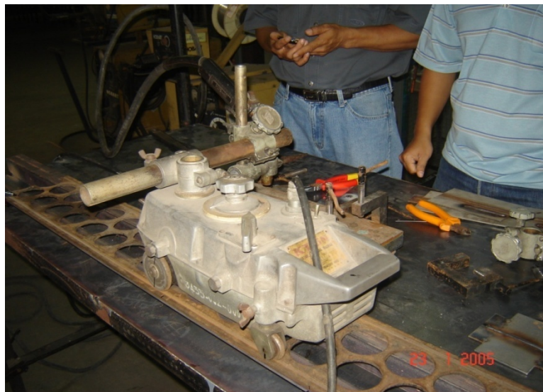
รูปที่ 3.3 เครื่องตัดแก๊สแบบเส้นตรงขับเคลื่อนด้วยมอเตอร์ รุ่น TANATA KT-5N
