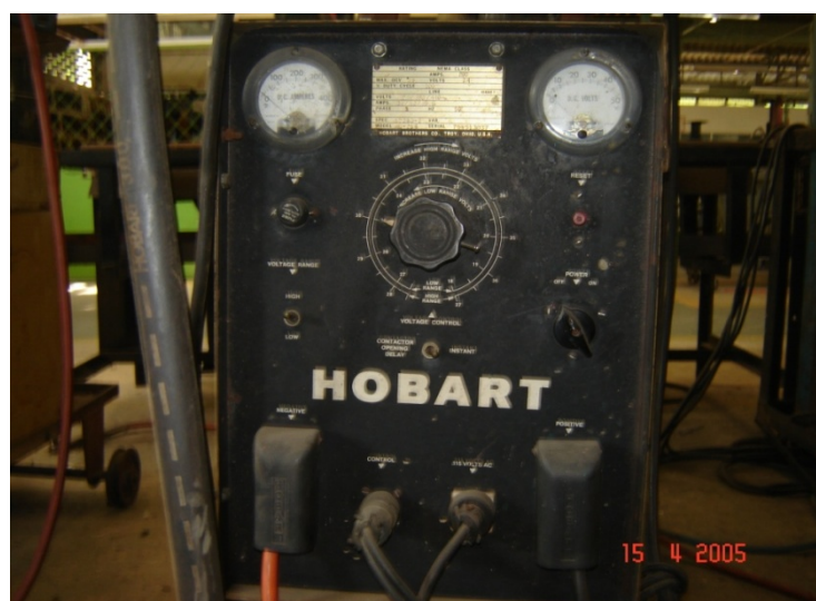
รูปที่ 3.1 เครื่องเชื่อมมิก (GMAW) รุ่น HOBART RC-256
