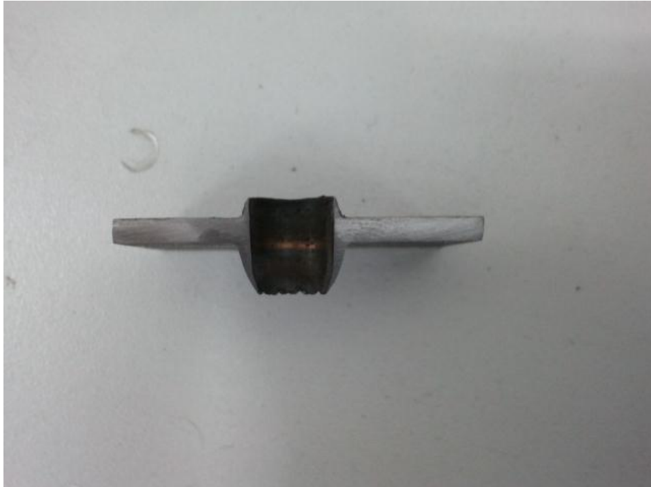
รูปที่ ค.11 พื้นที่หน้าตัดของชิ้นงานหลังจากการเจาะแรงเสียดทาน
