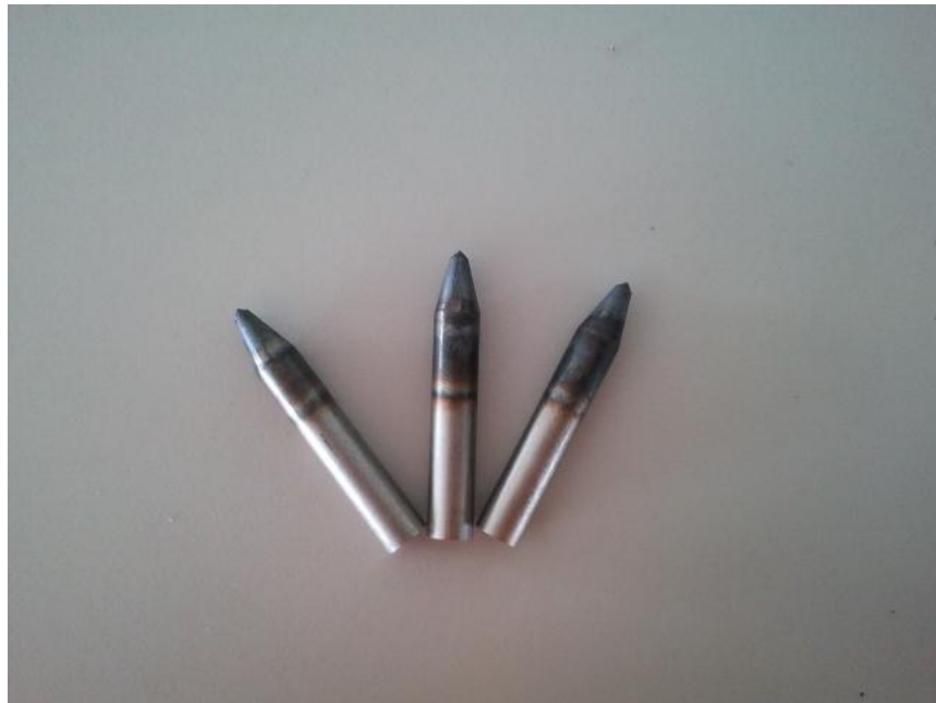
รูปที่ ค.6 ดอกเจาะคาร์ไบด์แท่งกลมที่ผ่านการเจาะด้วยแรงเสียดทาน
