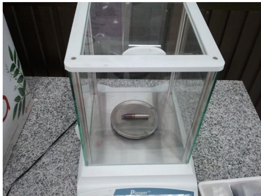
รูปที่ ค.4 รูปชั่งน้ำหนักดอกเจาะ Thernal drill
