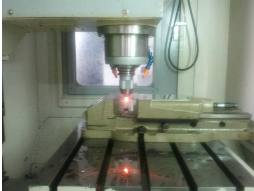
รูปที่ ค.5 เจาะชิ้นงานตามเงื่อนไขที่กำหนด
