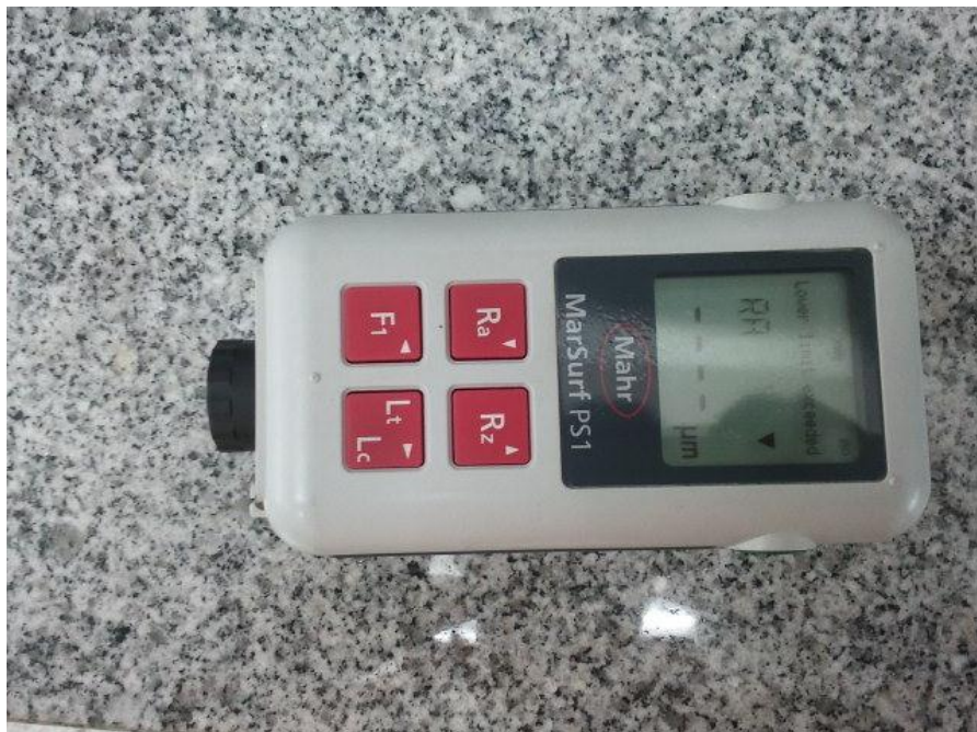
รูปที่ ค.8 เครื่องวัดความเรียบผิวของรูเจาะ
