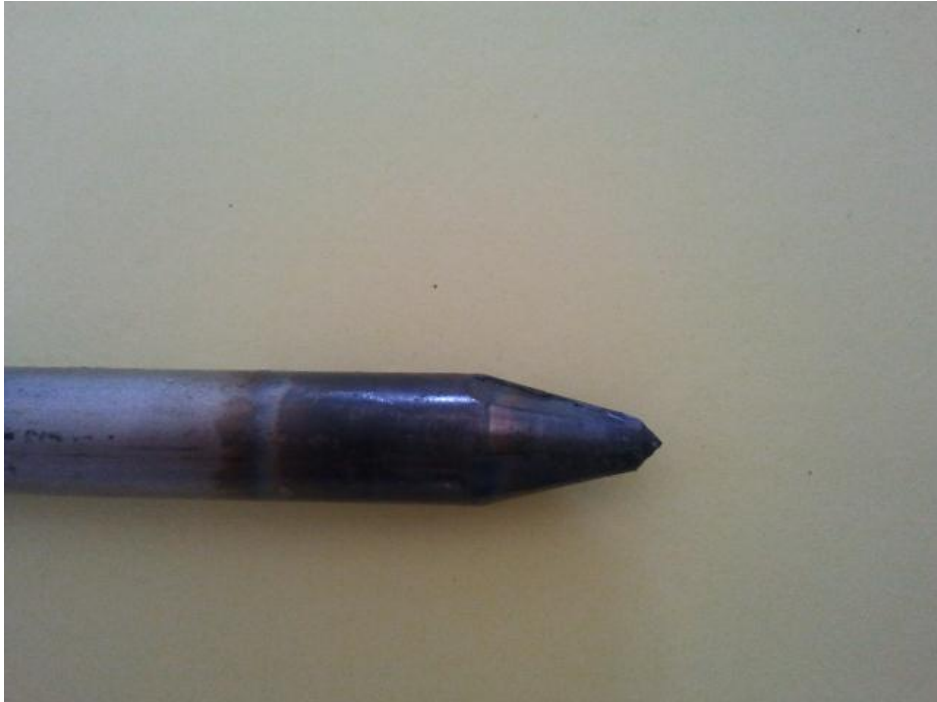
รูปที่ ค.9 รอยไหม้ที่เกิดขึ้นบนดอกเจาะและเศษโลหะที่เกาะที่ดอกเจาะ
