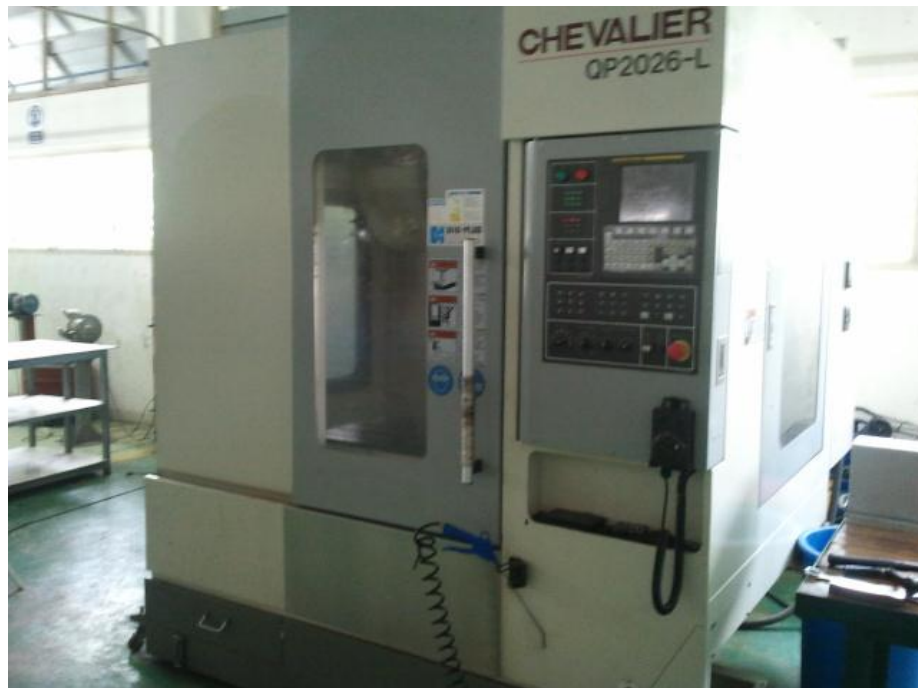
รูปที่ ค.3 เครื่องกัด ซี เอ็น ซี ใช้ในการเจาะยี่ห้อ Chevalier รุ่น QP2026 – L
