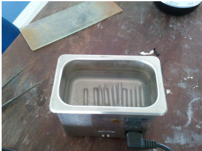
รูปที่ ค.2 การล้างดอกเจาะด้วยน้ำยา อซิโตน
