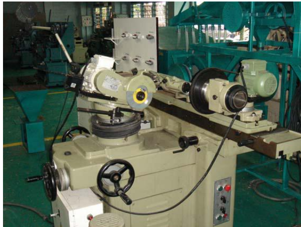
รูปที่ 3.5 เครื่องลับดอกเจาะ Thermal drill
