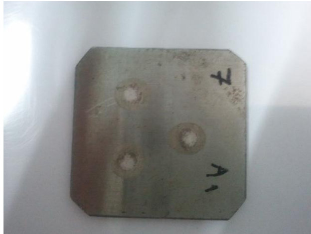
รูปที่ 3.7 ชิ้นงานทดสอบที่ใช้ในการทดสอบหาส่วนผสมทางเคมี
