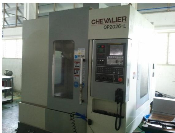
รูปที่ 3.4 เครื่องกัด CNC ยี่ห้อ Chevalier รุ่น QP2026 – L
