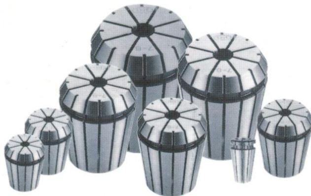
รูปที่ 2.8 ปลอกจับ ( Collet ) เครื่องมือตัดขนาดต่างๆ [6]
