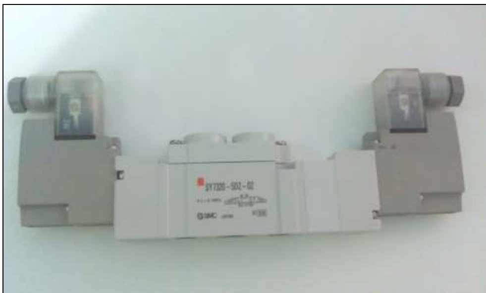
รูปที่ 2.3-5 Solenoid Value ที่จะใช้ควบคุมการยกและปรับระดับขึ้น/ลงของกระบอกลม
