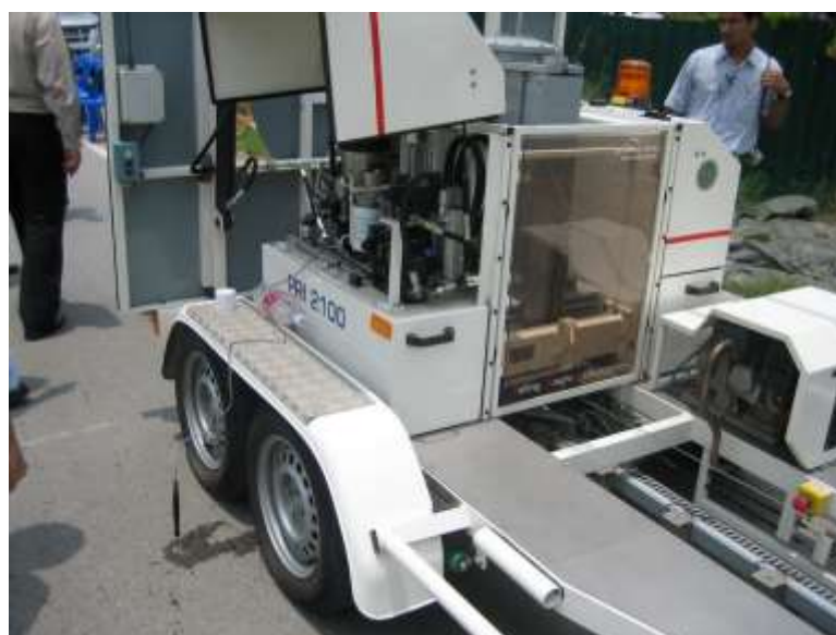
รูปที่ 2.4-2 FWD ของกรมทางหลวงชนบท รุ่น PRI 2100
