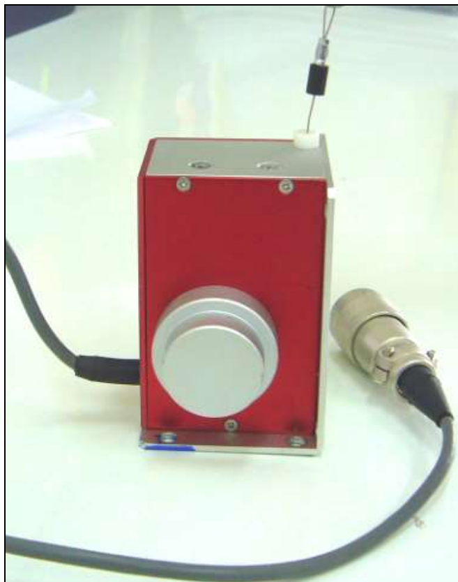
รูปที่ 2.3-4 ลักษณะของ Extensometer ที่จะใช้วัดความสูงของการยกตม้น้ำหนัก
