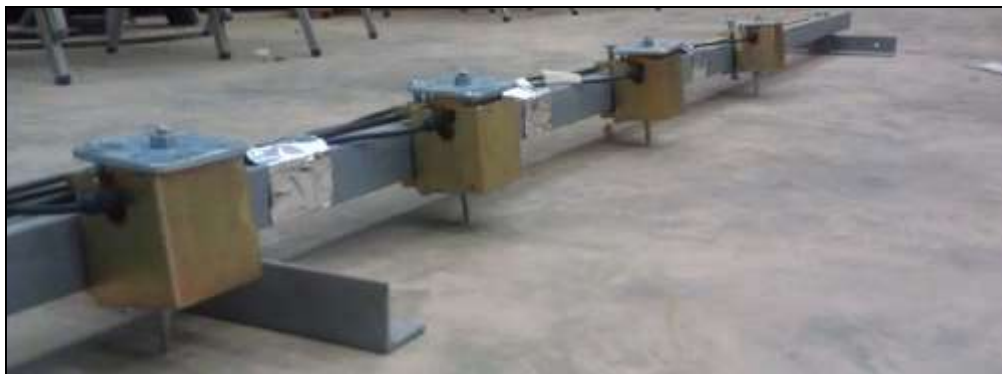
รูปที่ 2.4-6 การวัดค่าการแอ่นตัวโดยใช้ Geophone ที่ระยะต่างๆ ตามแนวรัศมีจากศูนย์กลางของแรงกระแทก
