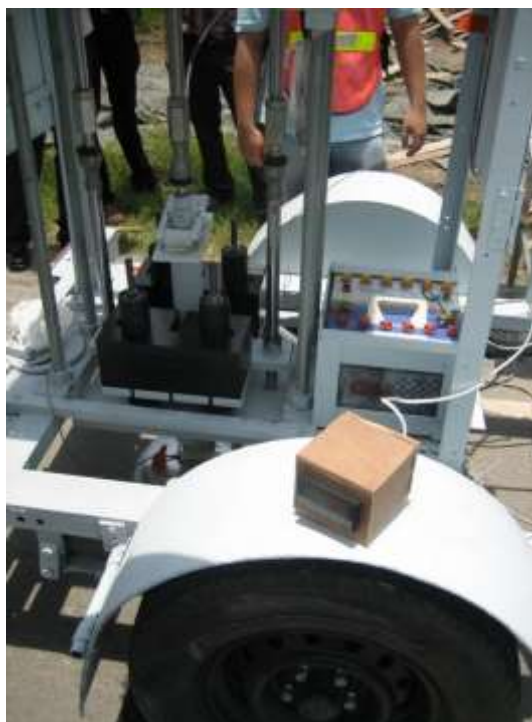
รูปที่ 2.4-3 เครื่องวัดการแอ่นตัวที่พัฒนาขึ้นมาใหม่ขณะทำการทดสอบบนถนนของกรมทางหลวงชนบท
