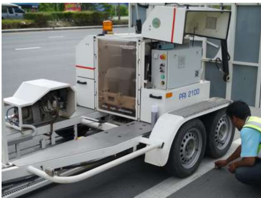
รูปที่ 2.4-7 การทดสอบด้วยเครื่อง FWD ของกรมทางหลวงชนบท
