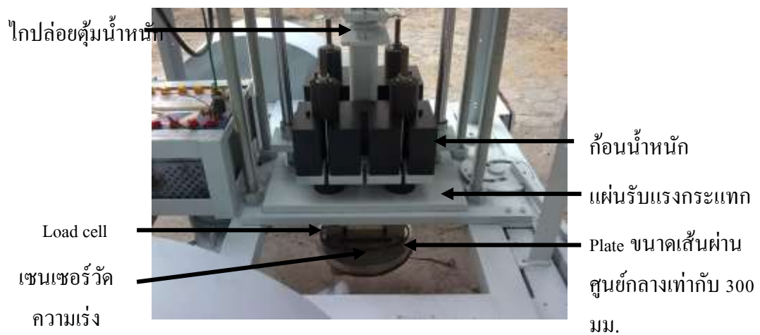
รูปที่ 2.3-3 ส่วนประกอบของเครื่องวัดการแอ่นตัวแบบตกกระแทก
