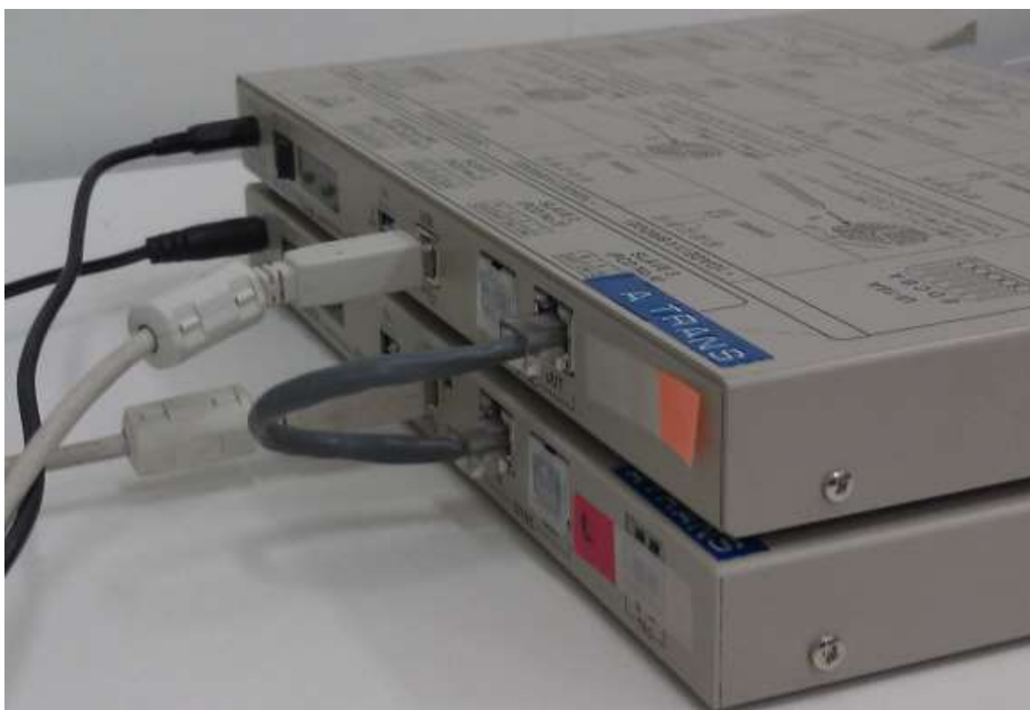
รูปที่ 2.3-17 Dynamic Data Logger และรูปแบบการต่อพ่วงแบบ Parallel
