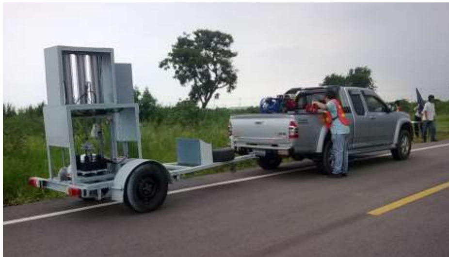
รูปที่ 2.4-1 เครื่องวัดการแอ่นตัวที่พัฒนาขึ้นมาใหม่
