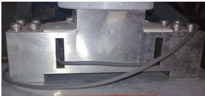
รูปที่ 2.3-9 Load cell ที่ใช้ในการทดสอบมีความสามารถในการรับแรงกระแทกถึง 15 ตัน
