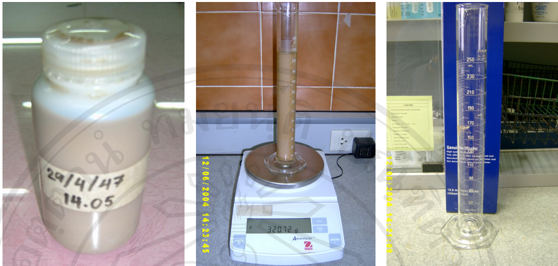
รูป 3.8 แสดงภาพขณะเก็บตัวอย่างน้ำขุ่น ภาชนะทรงกระบอกใสมีสเกลปริมาตร และการวัดค่าน้ำหนัก ด้วยเครื่องชั่งน้ำหนักอิเล็กทรอนิกส์
