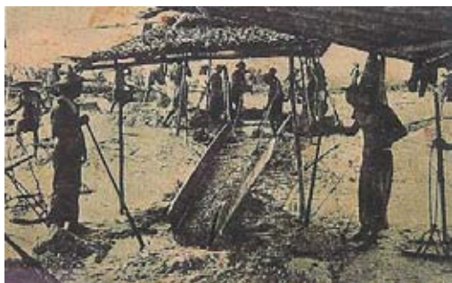
การทำเหมืองแร่แบบดั้งเดิมคือแบบเหมืองหาบ
