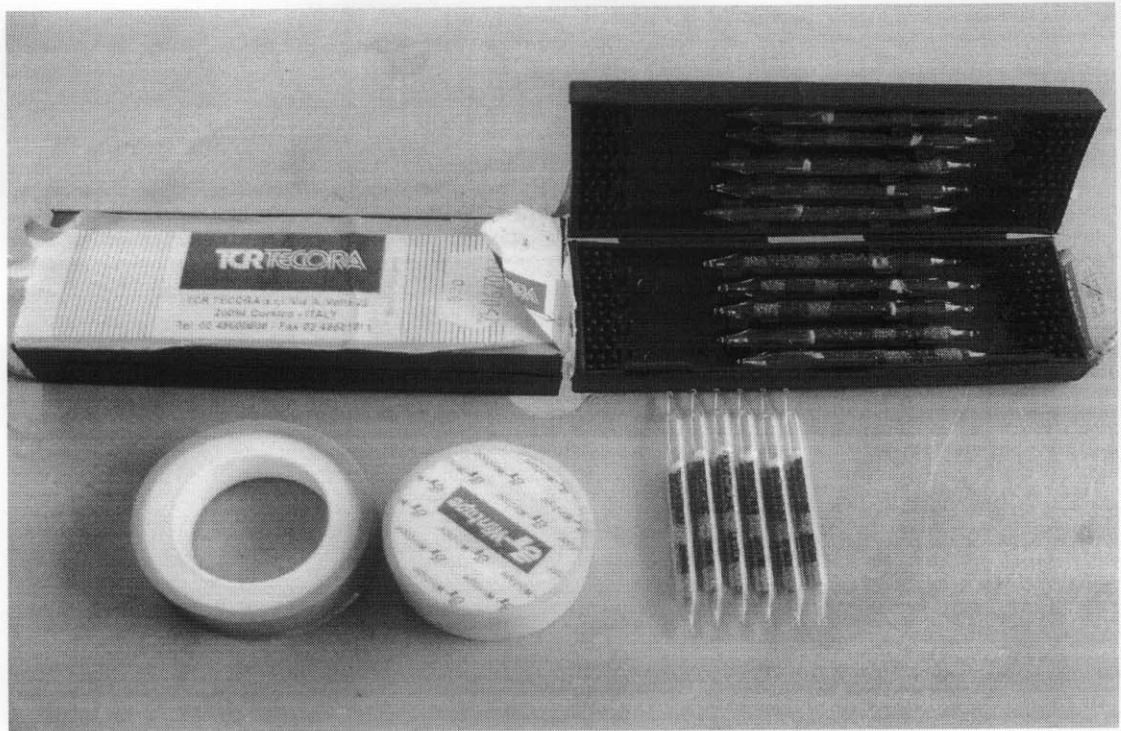
ภาพที่ 23 Activated Charcoal Tube และอุปกรณ์การเก็บอากาศ
