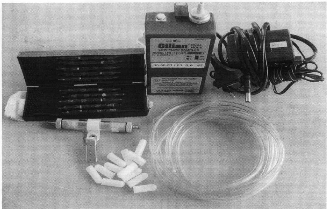
ภาพที่ 24 Low Flow Sampler pump พร้อมอุปกรณ์เก็บตัวอย่างอากาศ
