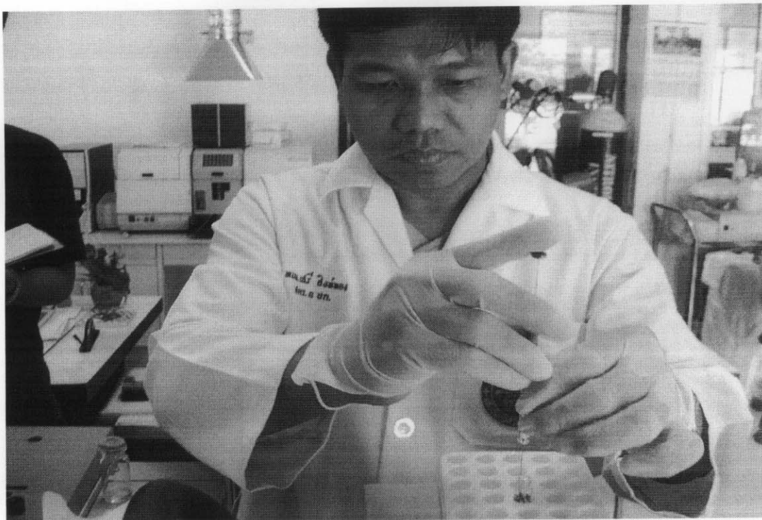
ภาพที่ 29 การดูดสารละลายเพื่อฉีดเข้าเครื่อง
