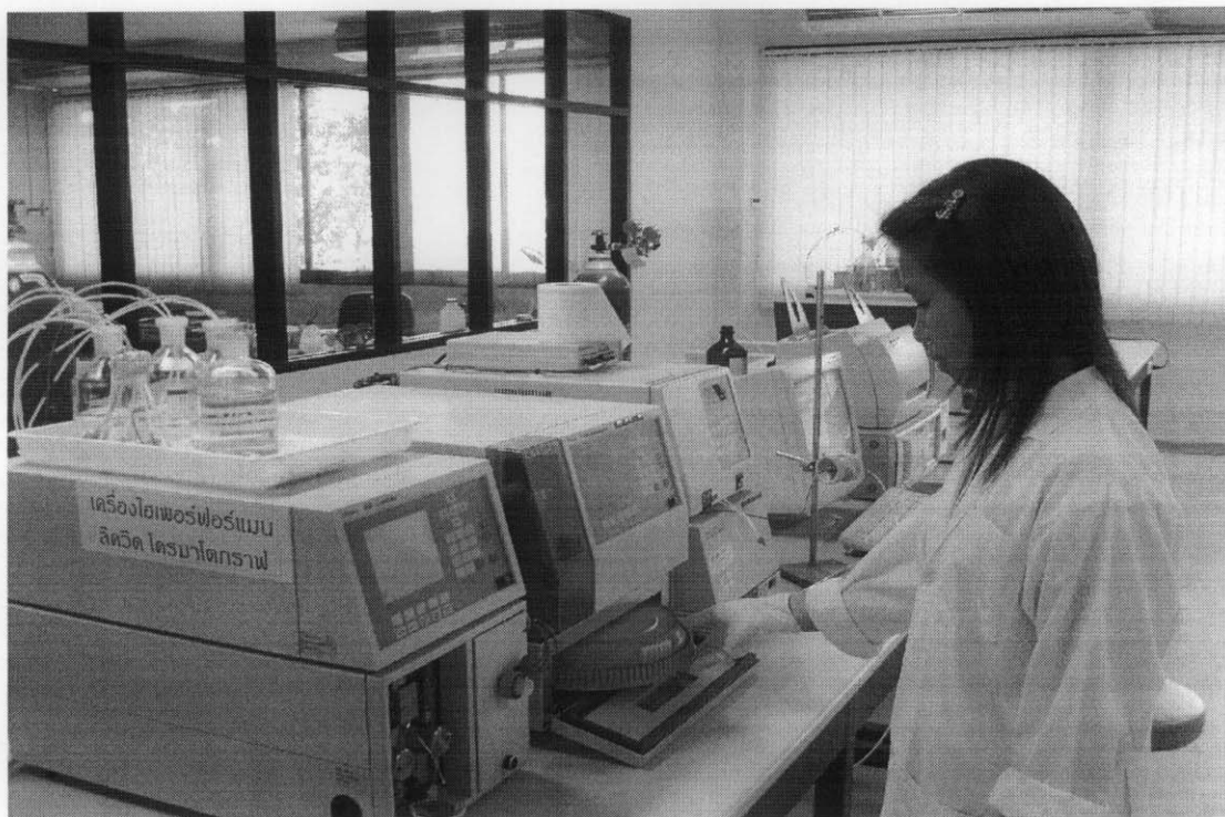
ภาพที่ 22 ทำการวิเคราะห์ตัวอย่างปัสสาวะด้วยเครื่อง HPLC
