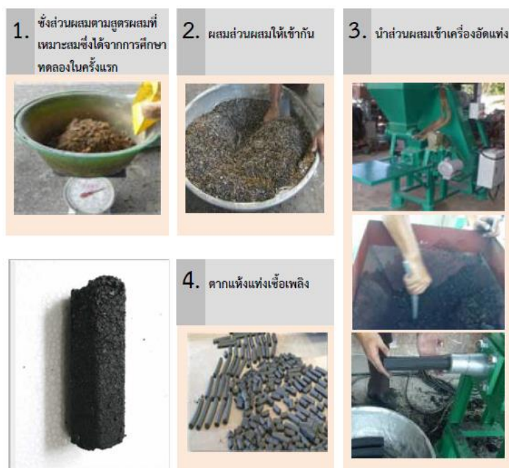
ภาพที่ 2.12 ขั้นตอนการผลิตแท่งเชื้อเพลิง [8]
