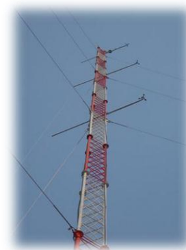
รูปที่ 2.3 ตัวอย่างเสาวัดอัตราเร็วและทิศทางลม ความสูง 120 เมตร
