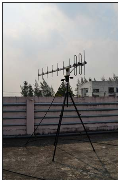
รูปที่ 3.39 การทดสอบการทำงานของ ozonesonde ที่เชื่อมต่อกับ radiosonde และเครื่องรับ-ส่งสัญญาณ
