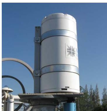
รูปที่ 3.11 เครื่องวัดรังสีอัลตราไวโอเลตแบบหลายช่องสัญญาณ รุ่น GUV-2511 ผลิตโดยบริษัท Biospherical Instrument ซึ่งติดตั้งที่ศูนย์อุตุนิยมวิทยาภาคเหนือ จังหวัดเชียงใหม่
