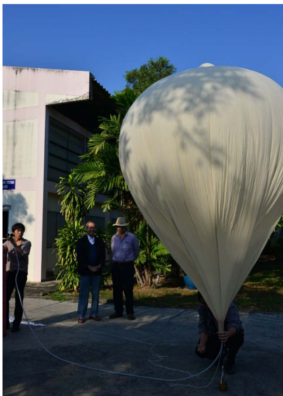
รูปที่ 3.40 การอัดก๊าซฮีเลียมเข้าไปในบัลลูนขนาด 1,600 g ที่กรมอุตุนิยมวิทยา บางนา
