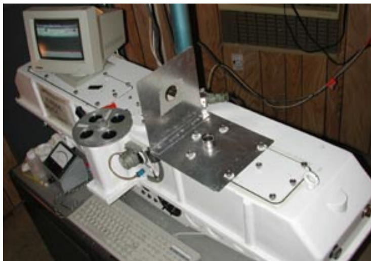
รูปที่ 3.23 เครื่อง Dobson spectrophotometer ซึ่งติดตั้งที่กรมอุตุนิยมวิทยา บางนา
