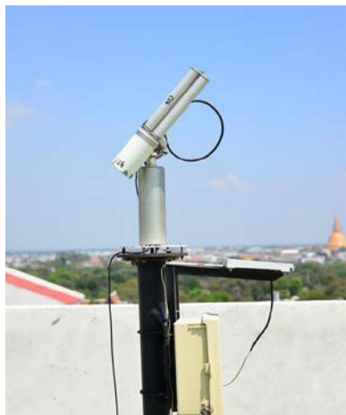
รูปที่ 3.6 เครื่องชันโฟโตมิเตอร์ซึ่งติดตั้งไว้ที่ตาดฟ้าชั้น 10 อาคารวิทยาศาสตร์ 1 คณะวิทยาศาสตร์ มหาวิทยาลัยศิลปากร จังหวัดนครปฐม
