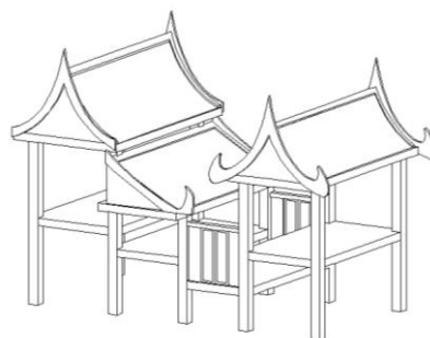
แบบสันนิษฐานที่ 11.3 บ้านเรือน ผังหลังคา, รูปด้าน และรูป 3 มิติ
