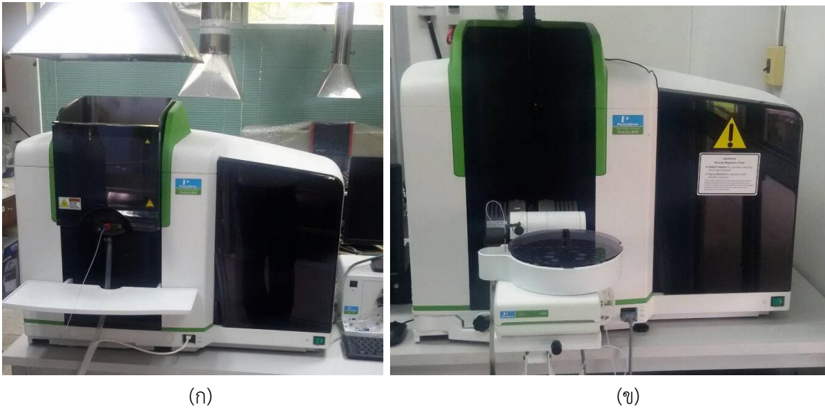
ภาพที่ 15 เครื่องมือวิเคราะห์โลหะหนักในกลุ่ม AAS : Flame Atomic Absorption Spectrometer (ก) และ Graphite Furnace Atomic Absorption Spectrometer (ข)
