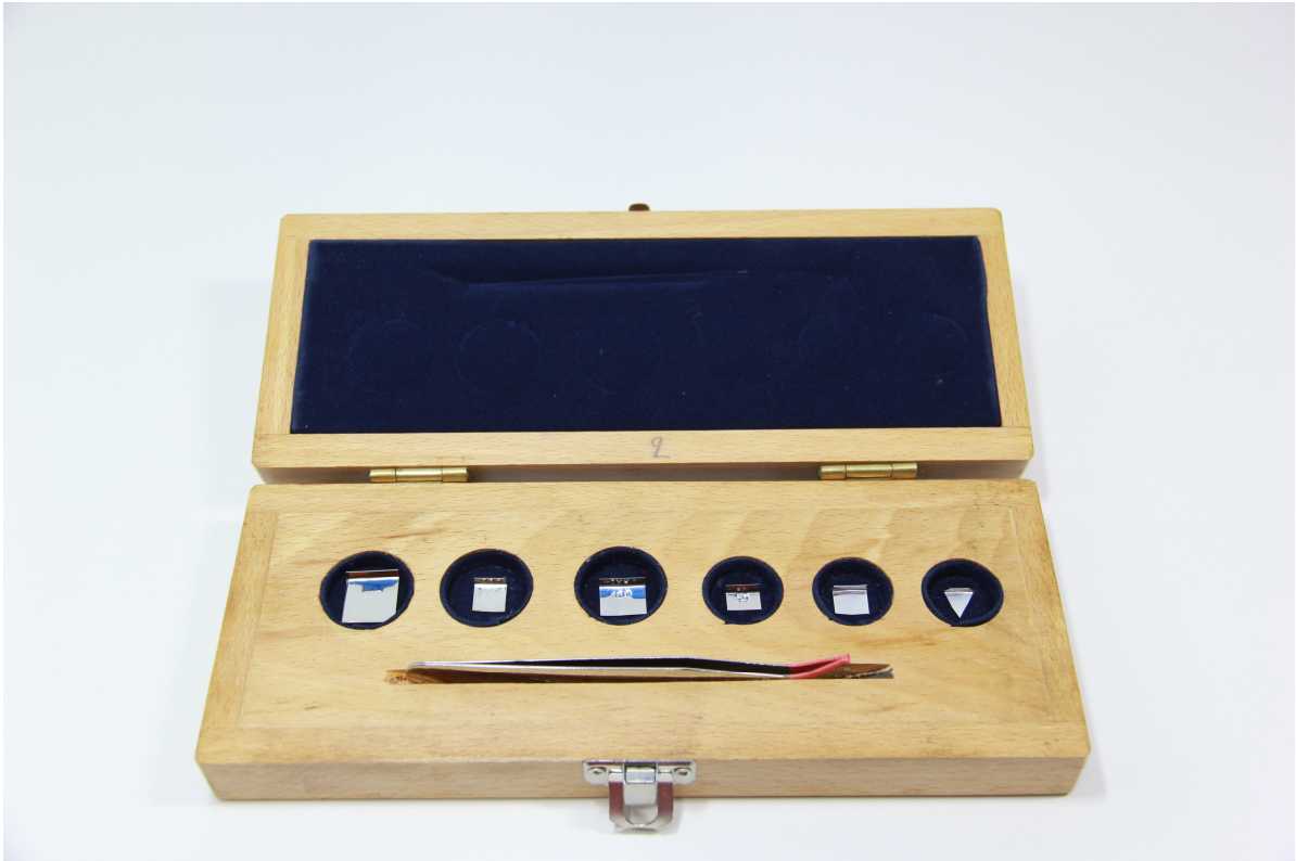
ภาพที่ 11 ตุ้มน้ำหนักที่ใช้ในการสอบเทียบเครื่องชั่ง
