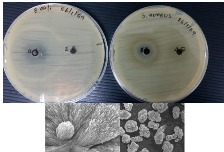
ภาพที่ ๕.6 ผลการศึกษา clear zone ของวัสดุของผสมซิงออกไซด์คอปเปอร์ออกไซด์ที่มีอนุภาคคอปเปอร์ออกไซด์เป็นหลักและมีลักษณะนาโนไวร์เกาะกลุ่มกัน กับเชื้อ E. coli และ S. aureus
