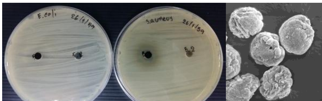
ภาพที่ ๕.7 ผลการศึกษา clear zone ของวัสดุของผสมซิงออกไซด์คอปเปอร์ออกไซด์ที่มีอนุภาคคอปเปอร์ออกไซด์เป็นหลักและมีลักษณะนาโนไวร์เกาะกลุ่มกันทรงกลมในลักษณะห่อปิดปลายนาโนไวร์ไว้ กับเชื้อ E. coli และ S. aureus
