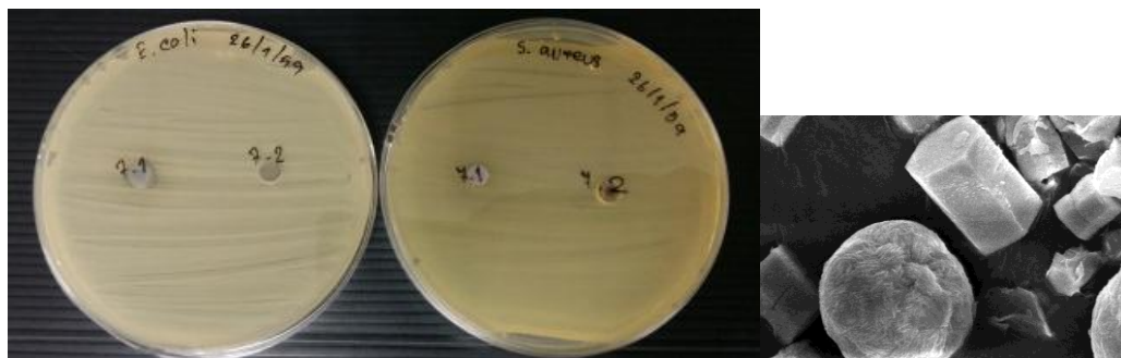
ภาพที่ ง.8 ผลการศึกษา clear zone ของวัสดุของผสมซึ่งออกไซด์คอปเปอร์ออกไซด์ที่สัดส่วนสารตั้งต้นในการสังเคราะห์ ซิงค์ต่อคอปเปอร์ 9 ต่อ 1 และมีลักษณะคอปเปอร์นาโนไวร์เกาะกลุ่มกันทรงกลม ผลึกซึ่งออกไซด์ที่มีขนาดใหญ่ มีประสิทธิภาพในการยับยั้งเชื้อ E. coli และ S. aureus ต่ำทั้งคู่
