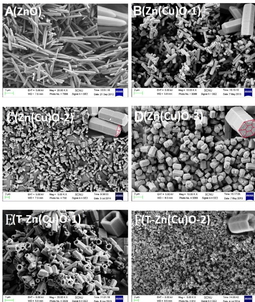
ภาพที่ 4.13 ตัวอย่างภาพถ่าย SEM ของอนุภาค ZnO, Zn(Cu)O, T-Zn(Cu)O และ T-Zn(Cu)O/Ag ของ Xia Wan และคณะ [83]
