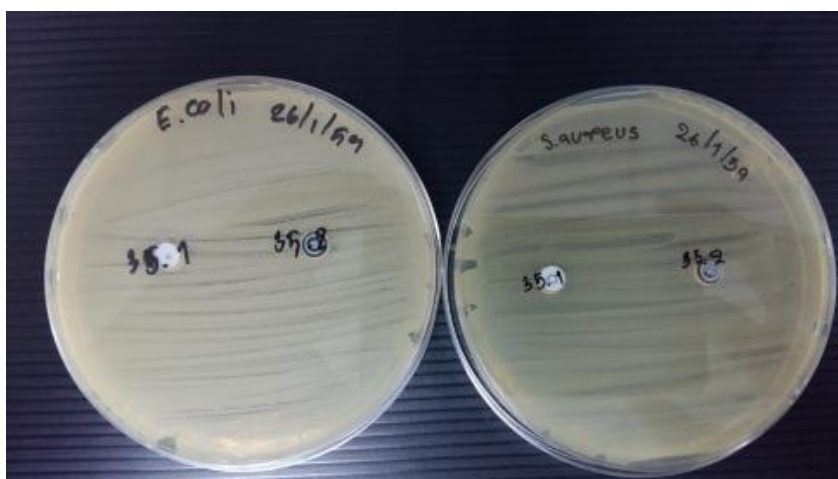
ภาพที่ ง.4 ผลการศึกษา clear zone ของซิงออกไซด์เกรดนาโนเมตร nanoZnO กับเชื้อ E. coli และ S. aureus เพื่อใช้เปรียบเทียบกับสารที่สังเคราะห์ขึ้น
