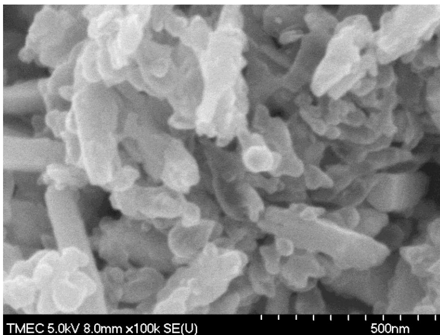
ภาพที่ ก.16 แสดงรายละเอียดลักษณะของอนุภาคที่สังเคราะห์ได้ที่กำลังขยายหนึ่งแสนเท่า
