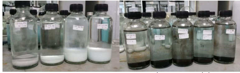
ภาพที่ 4.1 แสดงตัวอย่างตะกอนของสารของผสมตัวอย่างที่สังเคราะห์ได้ที่เงื่อนไขต่างๆ ด้วยเทคนิคการตกตะกอนร่วม โดยส่วนที่เป็นอนุภาคคอปเปอร์ออกไซด์มากจะมีสีดำเข้มมาก และส่วนที่มีอนุภาคซิงค์ออกไซด์มากจะมีสีขาวมากกว่า
