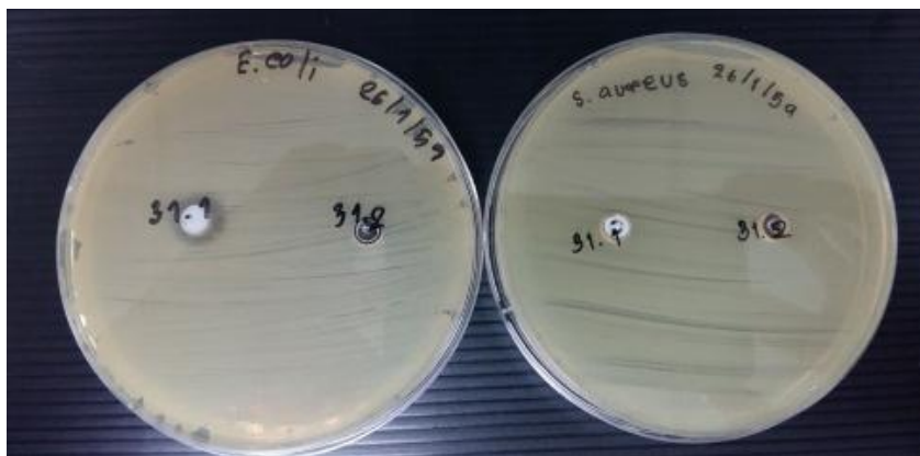
ภาพที่ ง.3 ผลการศึกษา clear zone ของซิงออกไซด์เกรดไมโครโนซ์ความบริสุทธิ์สูง 99.99% ZnO (Micronized Zinc Oxide) กับเชื้อ E. coli และ S. aureus เพื่อใช้เปรียบเทียบกับสารที่สังเคราะห์ขึ้น
