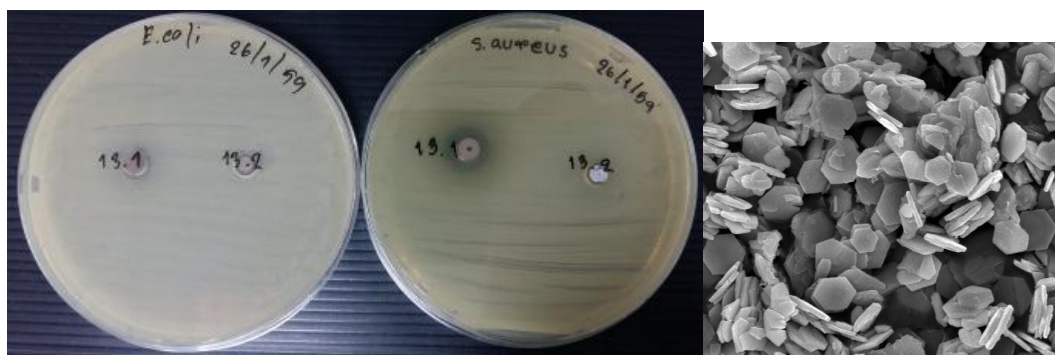
ภาพที่ ง.10 ผลการศึกษา clear zone ของวัสดุของผสมซึ่งออกไซด์คอปเปอร์ออกไซด์ที่สัดส่วนสารตั้งต้นในการสังเคราะห์ ซิงค์ต่อคอปเปอร์ 9 ต่อ 1 และมีลักษณะผลึกซึ่งออกไซด์ที่มีรูปร่าง hexagonal disk มีประสิทธิภาพในการยับยั้งเชื้อ S. aureus ที่ดีขึ้นและดีกว่าการยับยั้งเชื้อ E. coli
