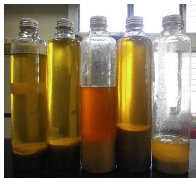
ภาพ 4.1 น้ำมันที่สกัดด้วยเครื่องหีบแบบอัดเกลียวแบบอัดเกลียว
