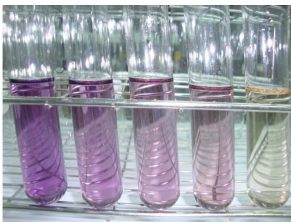
ภาพ 4.8 การทดสอบการยับยั้งอนุมูลอิสระโดยวิธี DPPH
