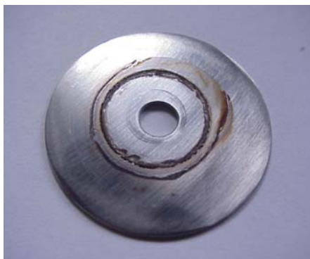
ภาพที่ 3-6 การเกิดการกัดกร่อนบริเวณภายใต้รอยซ้อนของขั้วอิเล็กโทรดทำงานของเหล็กกล้าไร้- สนิม AISI 409 ในสารละลายโซเดียมคลอไรด์ความเข้มข้น 0.5 โมลาร์ ที่อุณหภูมิ 50°C เป็นระยะเวลา 24 ชั่วโมง [23]
