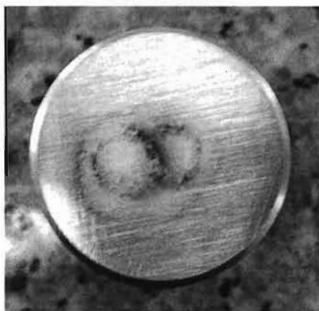
รูปที่ ค.21 ชิ้นงานมีส่วนผสมประกอบด้วย Fe = 97.3329 %, S = 0.011 %, C = 0.396 %, Cr = 0.915 %, Si = 0.215 %, Ni = 0.120 %, Sn = 0.011 %, Mn = 0.634 %, Mo = 0.157 %, Al = 0.019 %, Cu = 0.167 % และอื่นๆ = 0.0221 %
