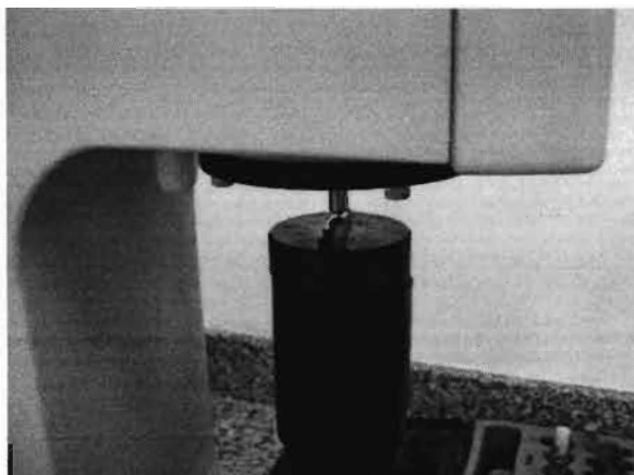
รูปที่ ค.19 ทดสอบหาค่าความแข็งของมีดกลึง ทดสอบได้ 58-62 HR C
