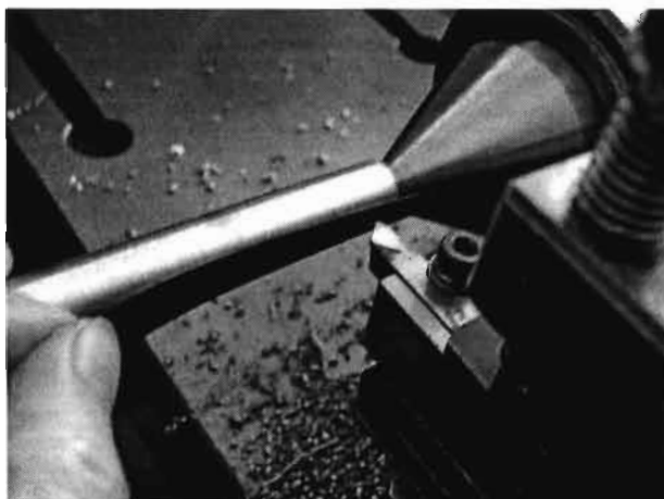
รูปที่ ค.8 ตั้งระยะมีดกลึงโดยใช้ Filler garge สำหรับการป้อนลึก 1 มม.
