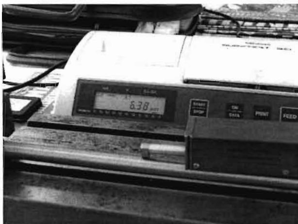
รูปที่ ค.16 วัดค่าความเรียบของพื้นผิวงานกลึงที่ตำแหน่งที่สอง
