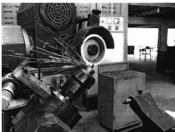
รูปที่ ค.2 การถับมีดกลึงให้ได้มุมตามที่กำหนดไว้ในการทดลอง
