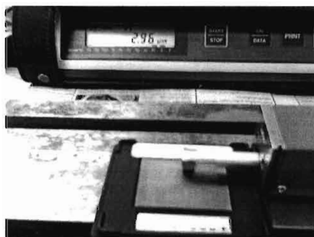
รูปที่ ค.14 การปรับเทียบเครื่องวัดค่าความเรียบของพื้นผิวกับแผ่นมาตรฐาน
